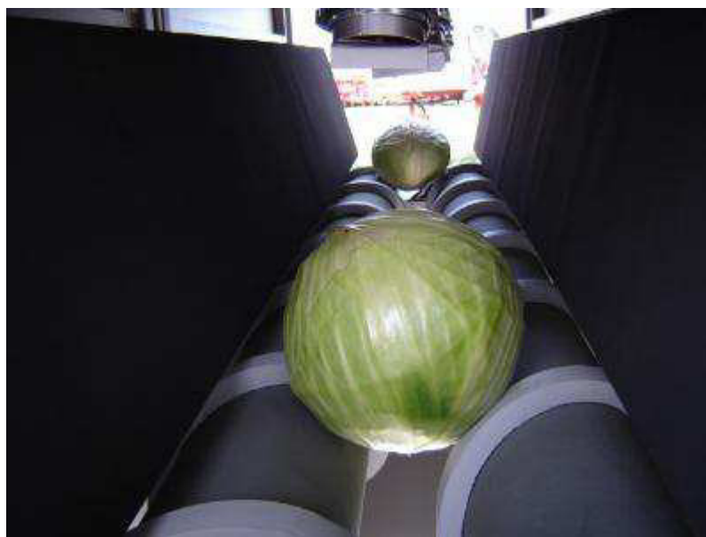
Рис. 1.10. Принцип роботи очисного пристрою пропонованої машини
