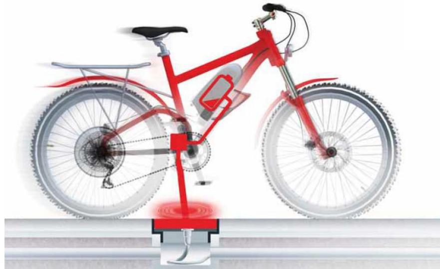
Рисунок 1.3 – Бездротова зарядка електричних велосипедів, запропонована SEW Eurodrive
