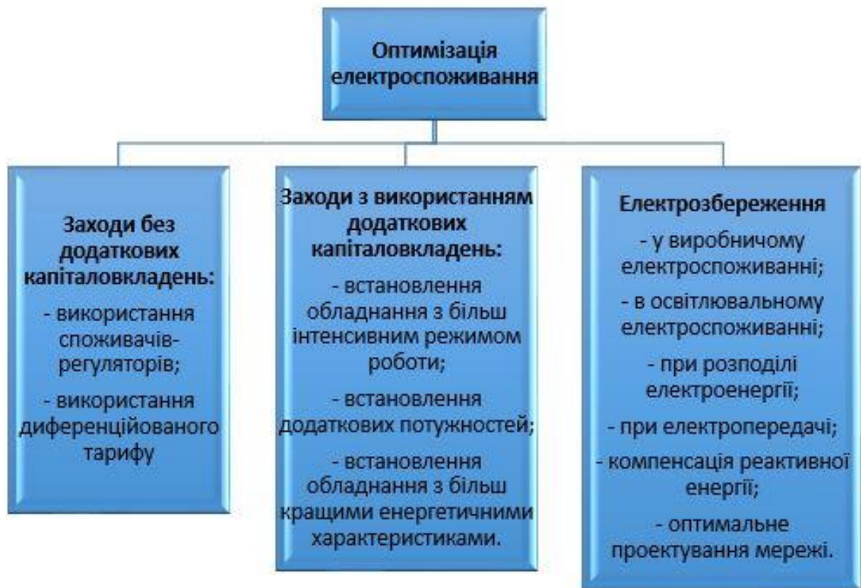
Рисунок 1.2 – Структура енергоефективної системи електропостачання аміачної компресорної станції
