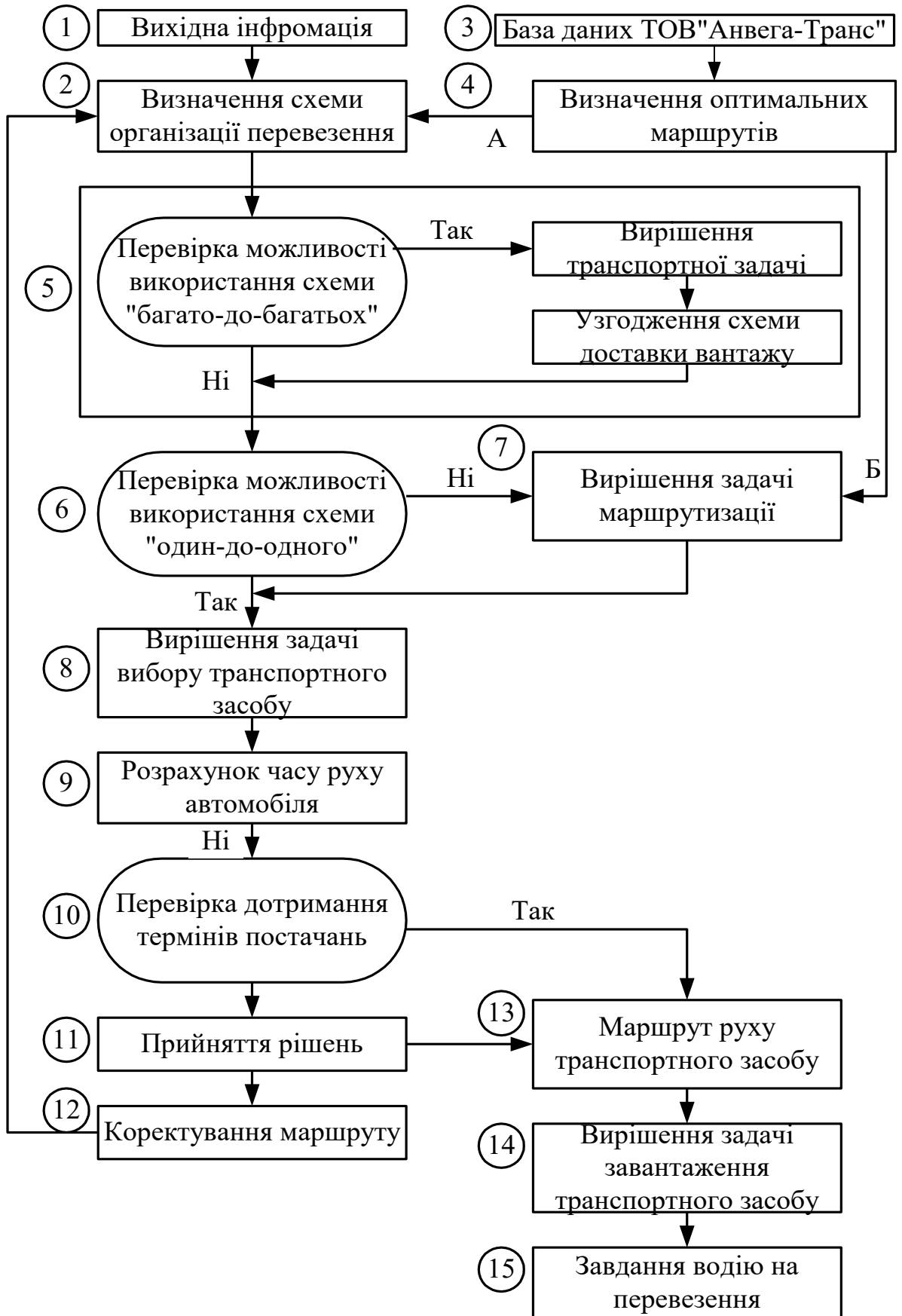
Рис. 2.13. Транспортно-технологічна схема організації перевезень на ТОВ «Анвега-Транс»
