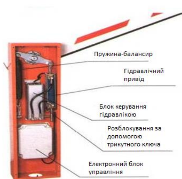
Рис. 1.4. Структура гідравлічного шлагбаума
