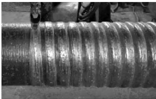
Рис. 1.6. Наплавлений ролик МБЛЗ із зазорами між наплавленими валиками [39]
