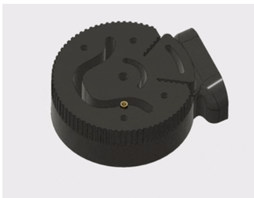
Рис. 3.9 Встановлення термоплавких вставок в плечовий суглоб
