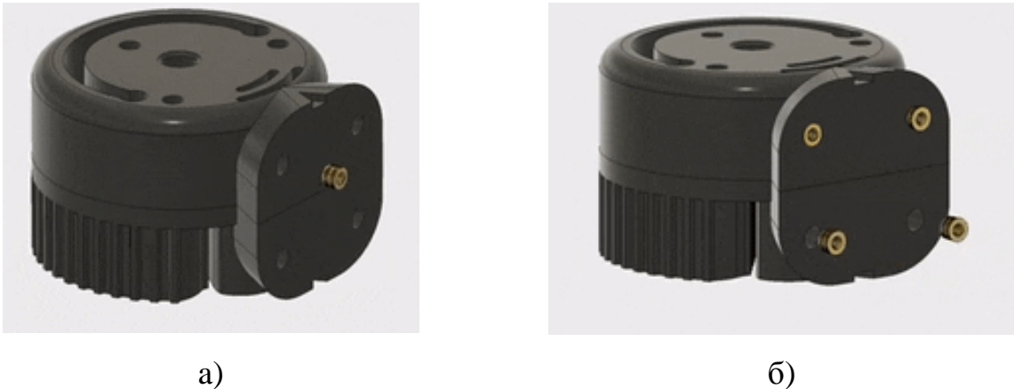
Рис. 3.53 Встановлення термоплавких вставок в основу зап'ястя
