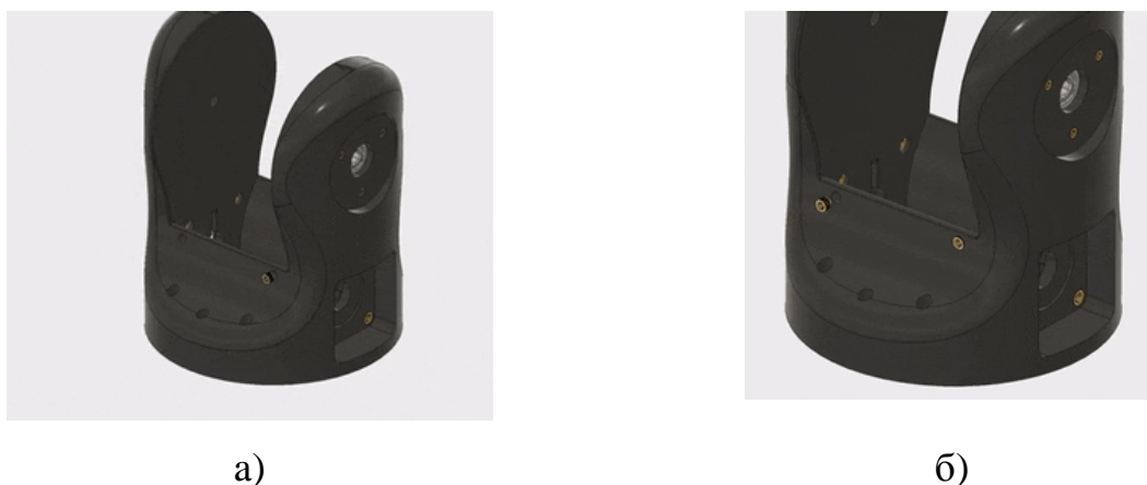
Рис. 3.14 Встановлення термоплавких вставок у тильній стороні
