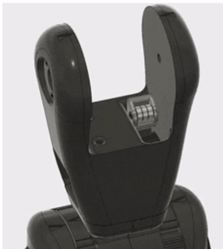
Рис. 3.30 Встановлення натягувача ліктьового ременя
