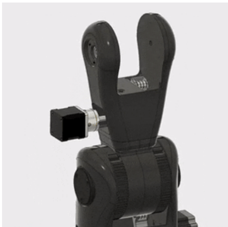
Рис. 3.32 Встановлення ліктьового двигуна
