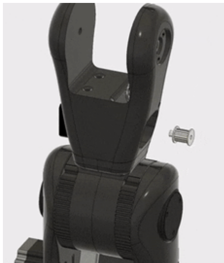
Рис. 3.33 Додавання шківів ременя до ліктьового двигуна
