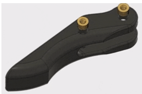
Рис. 3.63 Встановлення термоплавких вставок в затискачі
