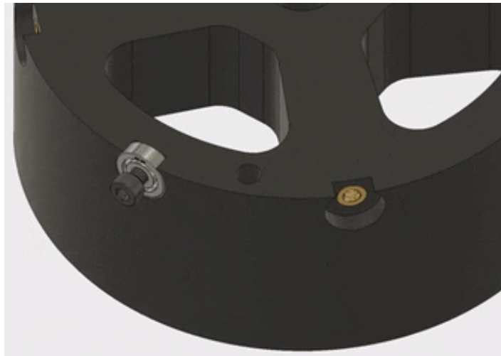
Рис. 3.5 Закріплення підшипників до основи
