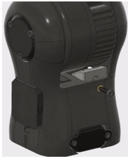
Рис. 3.56 Встановлення гвинта натягувача зап'ястя
