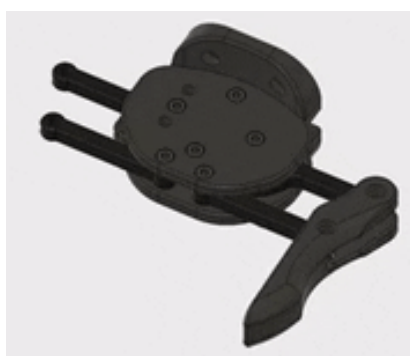
Рис. 3.64 Підключення затискачів до захоплювача
