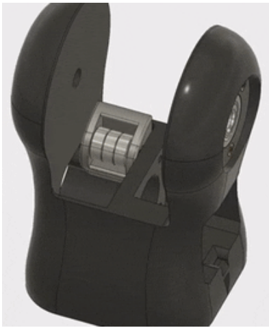
Рис. 3.46 Встановлення натягувача зап'ястя
