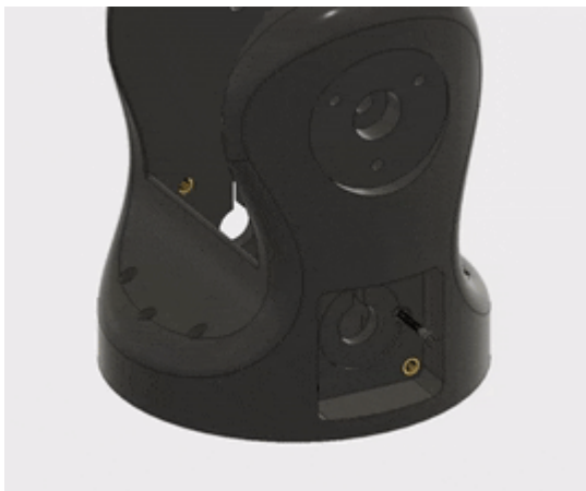
Рис. 3.17 Встановлення гвинта для натягувачів базового ременя
