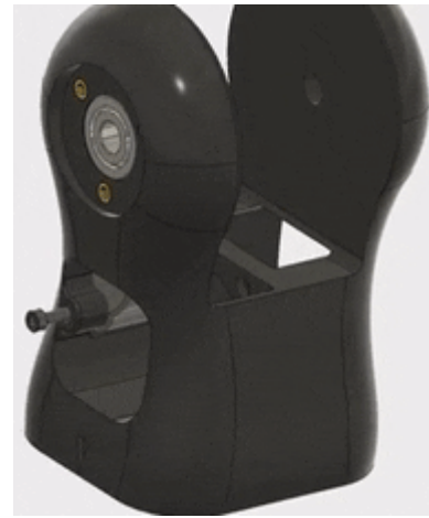
Рис. 3.46 Встановлення натягувача зап'ястя
