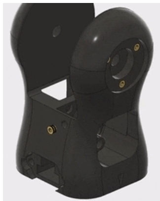
Рис. 3.41 Встановлення термоплавкої вставки вище прямокутного вирізу
