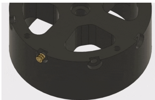
Рис. 3.3 Встановлення термоплавких вставок
