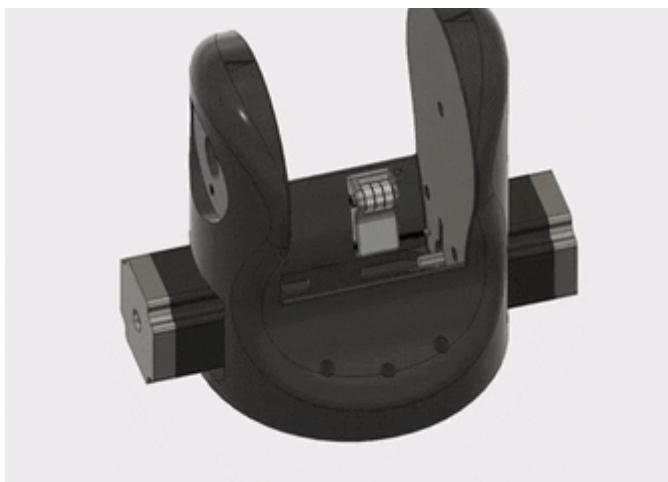
Рис. 3.18 Встановлення натягувачів базового ременя
