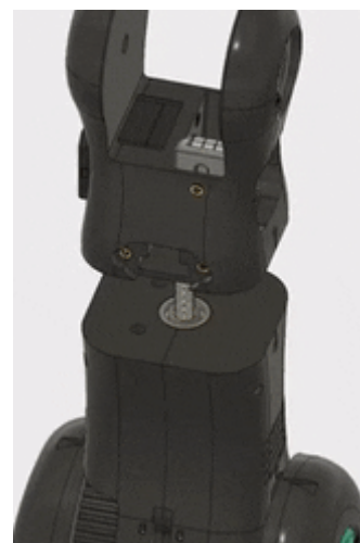
Рис. 3.48 З'єднання зап'ястя та ліктьового суглоба
