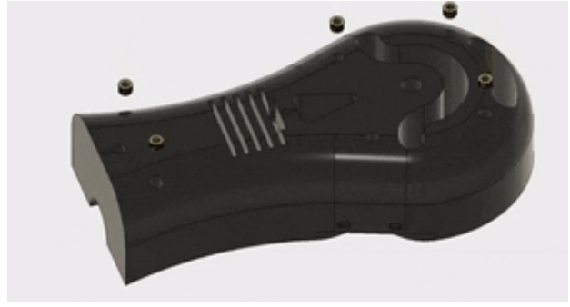
Рис. 3.34 Встановлення термоплавких вставок в ліктьовий згин
