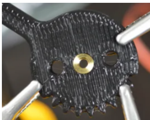
Рис. 3.60 Встановлення термоплавких вставок в кронштейн шестерні А захоплювача
