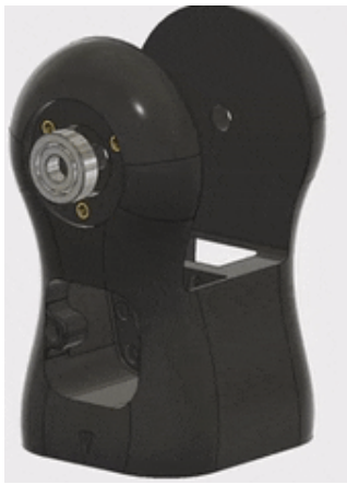
Рис. 3.43 Додавання кулькових підшипників на зап'ястя
