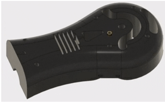
Рис. 3.34 Встановлення термоплавких вставок в ліктьовий згин
