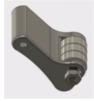
Рис. 3.15 Збірка натягувачів базового ременя
