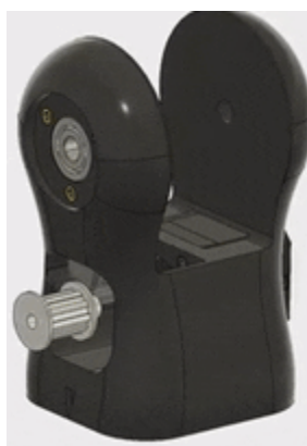
Рис. 3.50 Додавання ремінного шків до зап'ястного двигуна
