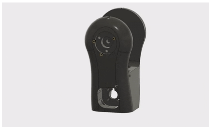
Рис. 3.25 Встановлення термоплавких вставок в основу ліктя
