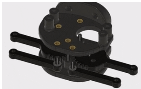
Рис. 3.62 Закріплення нижньої пластини захоплення
