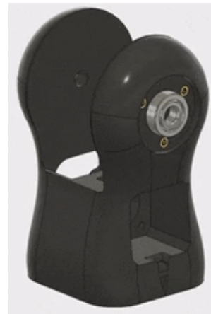
Рис. 3.43 Додавання кулькових підшипників на зап'ястя
