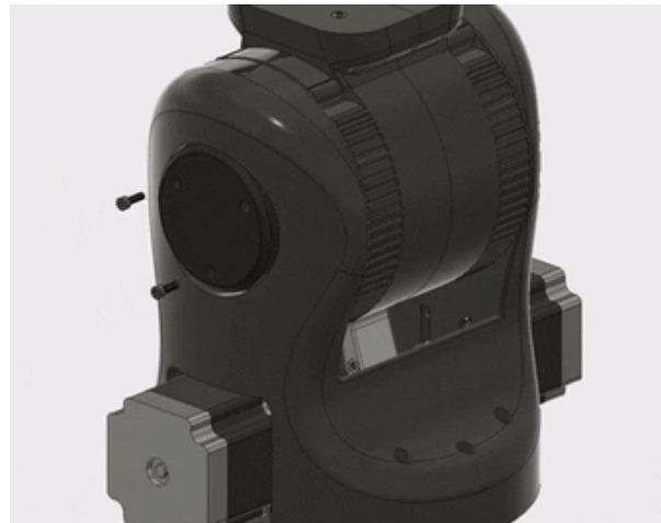
Рис. 3.24 Закріплення кришок плечових валів
