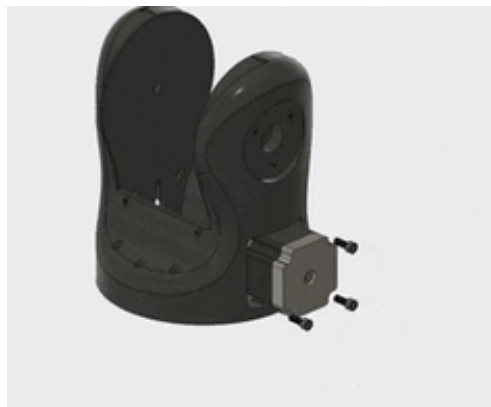
Рис. 3.19 Додавання двигунів Nema 23 до плечової основи
