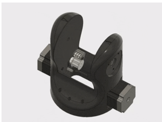
Рис. 3.20 Додавання ремінних шківів до двигунів Nema 23
