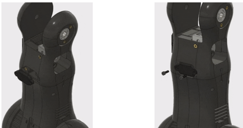
Рис. 3.49 Закріплення задньої кришки зап'ястя
