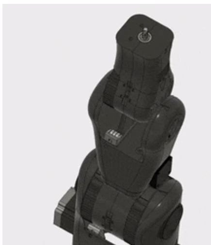
Рис. 3.38 Встановлення ліктьового суглоба на підставу ліктя
