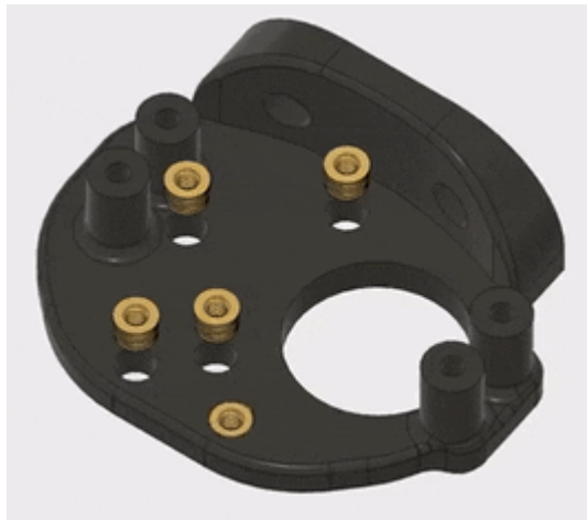
Рис. 3.57 Встановлення термоплавких вставок в нижню пластину захоплювача
