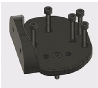
Рис. 3.58 Додавання гвинтів до верхньої пластини захоплювача
