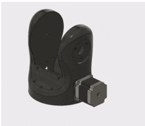
Рис. 3.19 Додавання двигунів Nema 23 до плечової основи
