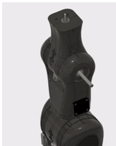
Рис. 3.38 Встановлення ліктьового суглоба на підставу ліктя
