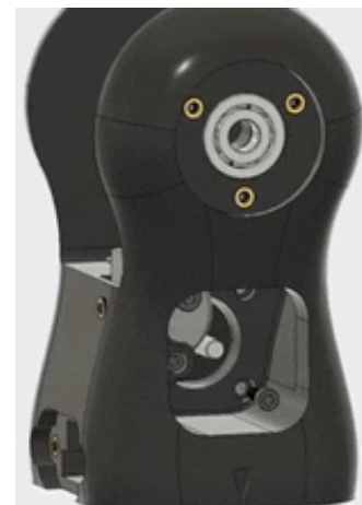
Рис. 3.47 Закріплення зап'ясткового двигуна 2
