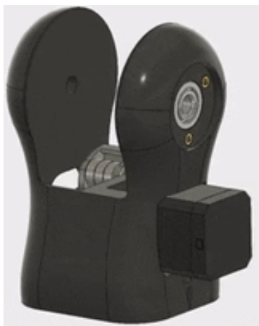
Рис. 3.47 Закріплення зап'ясткового двигуна 2
