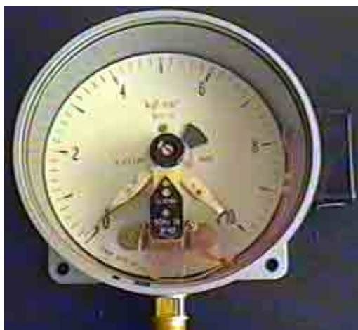
Рисунок 4.1 – Зовнішній вигляд електроконтактного манометру ЭКМ-1У
