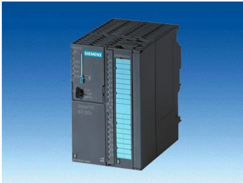
Рисунок 4.10 – Зовнішній вигляд мікроконтролера CPU 312C.
