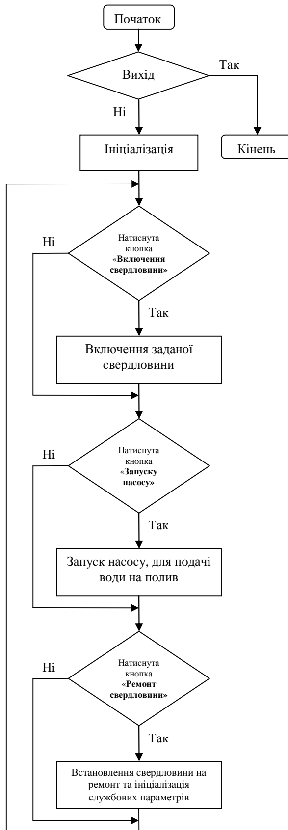
Рисунок 4.7 - Алгоритм роботи ручного режиму управління роботою системи.
