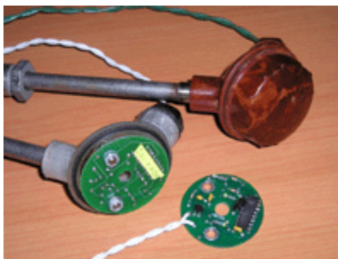
Рисунок 2.20 – Зовнішній вигляд перетворювача температури ТП-150
