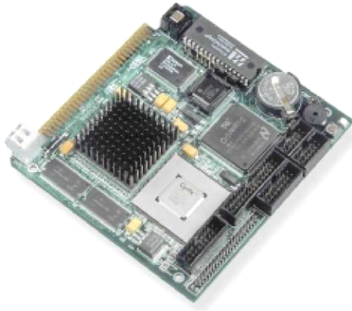
Рисунок 2.10 – Зовнішній вигляд процесорного модуля CPU686
