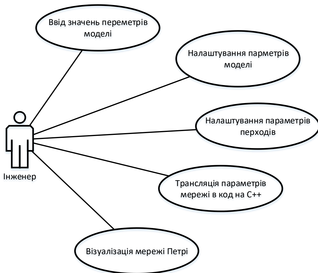
Рис. 3.1. Вимоги до програмного забезпечення трансляції мережі Петрі у програмний код на мові C++
