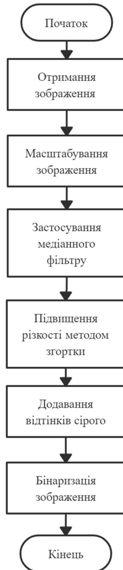
Рис. 3.1. Блок-схема повного алгоритму опрацювання зображення БК
