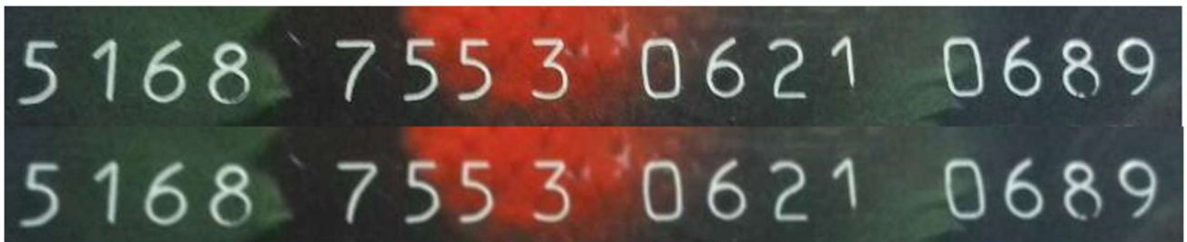
Рис. 2.3 – результат роботи лінійного фільтра(зверху вхідне зображення, знизу вихідне зображення)
