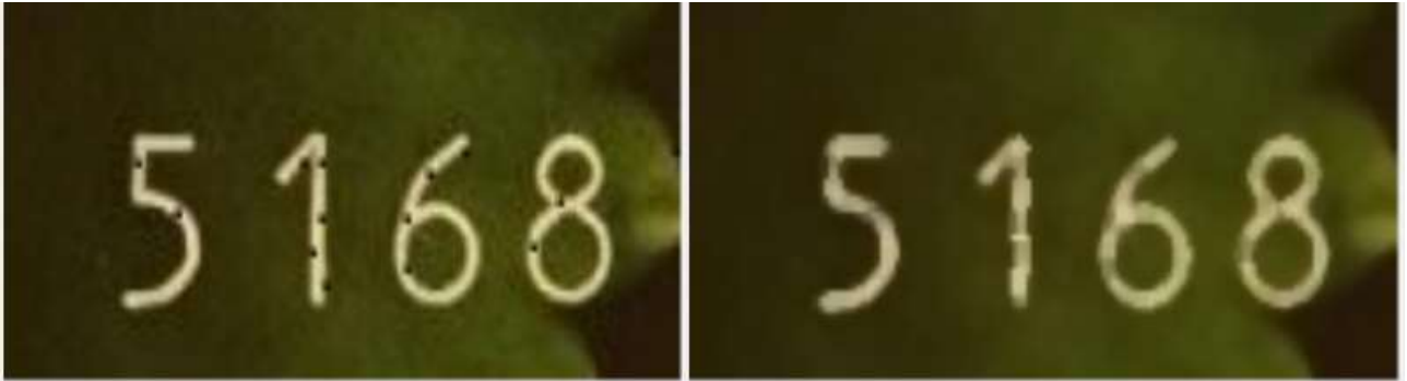
Рис. 3.3 – застосування медіанної фільтрації до зображення
