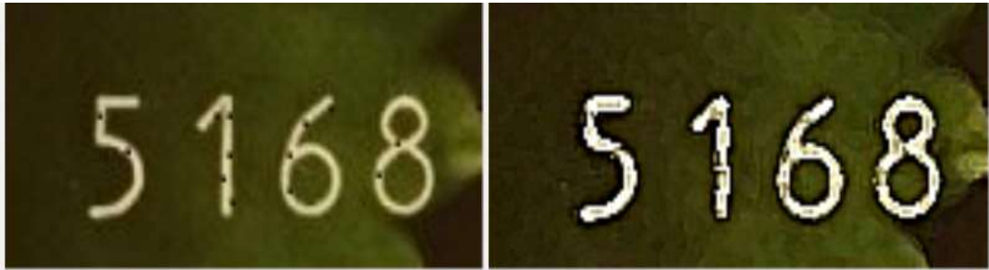
Рис. 3.5 – результат застосування медіанного фільтра разом із фільтрацією методом згортки
