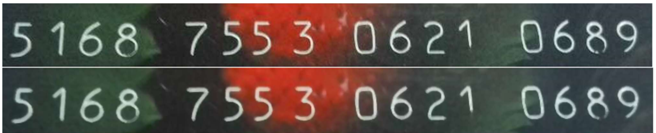
Рис. 2.5 – результат роботи медіанного фільтра
