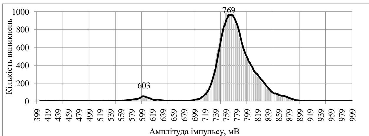
Рис. 3.7. Гістограма частоти виникнення певних амплітуд імпульсів на виході ДГМ при впливі зразка з радіонуклідом ^{90}\text{Sr} - ^{90}\text{Y}
