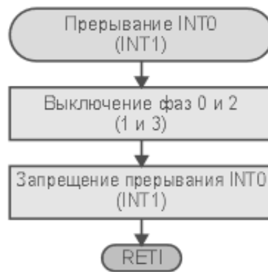
Рисунок 5.2 – Блок-схема оброблювача переривань INT0 і INT1
