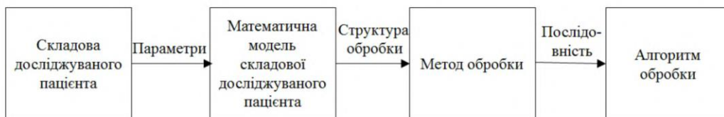
Рис.2. Структура процедури обробка даних у комп'ютерних експертних системах
