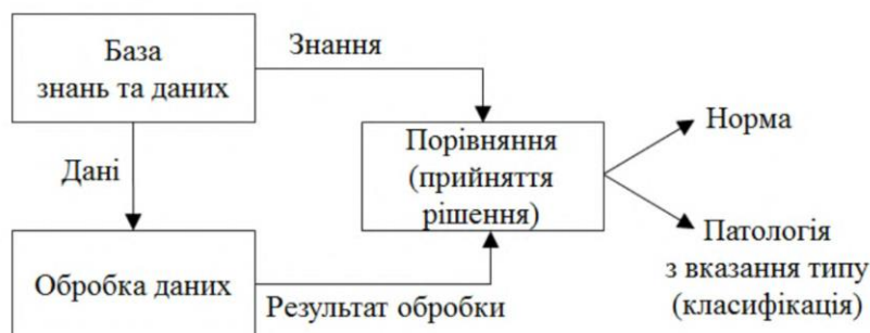
Рис.3. Структура прийняття рішення у комп'ютерних експертних системах
