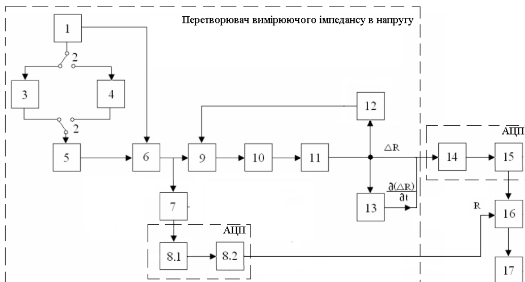
Рис. 2.2. Розширена структурна схема реєстраторці реосигналу РЕО
