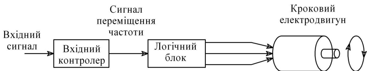
Рисунок 2.14 - Схема керування кроковим електродвигуном
