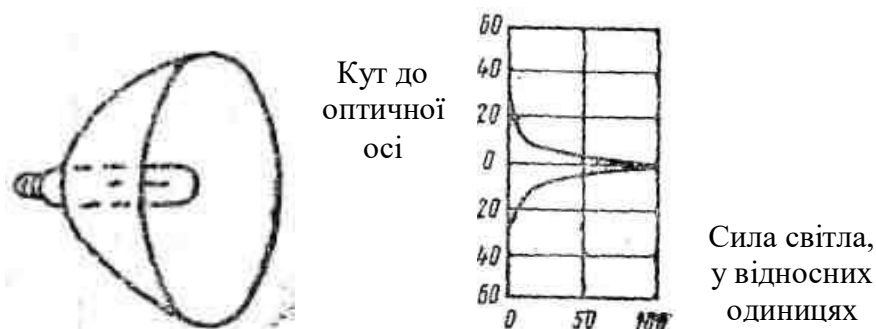
Рис. 6. Прожектор з параболічним відбивачем
