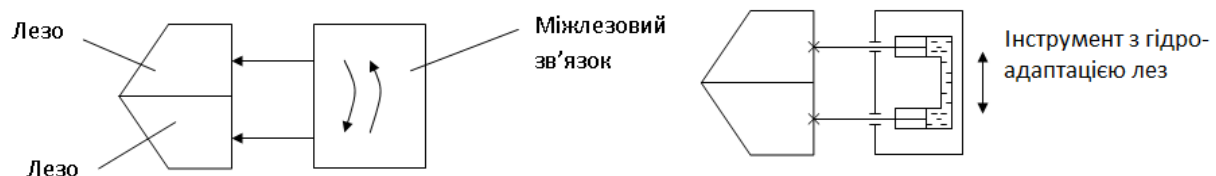
Рис. 1. Функціональна схема дволезового свердла з гідroadаптацією різальних лез
