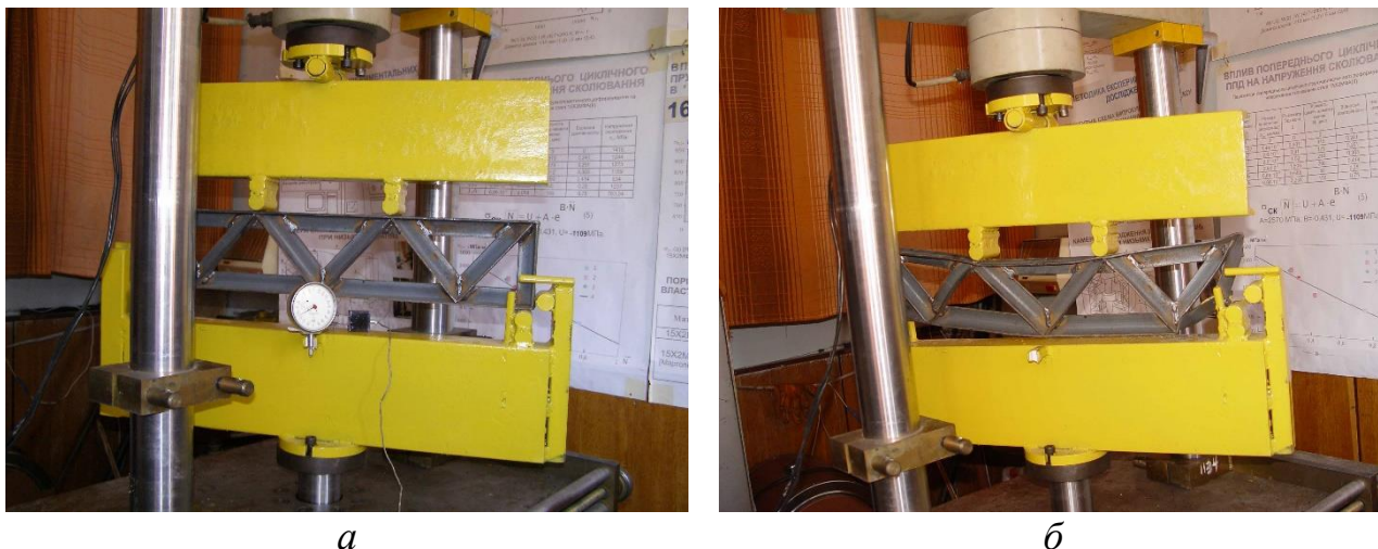
Рисунок 1.4 – Зразок зварної ферми на випробувальному комплексі СТМ-100 перед навантаженням (а) та після руйнування (б) [35]
