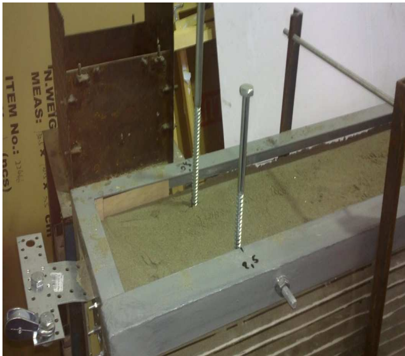
Рисунок 2.6 - Занурення модельних паль в ґрунт
