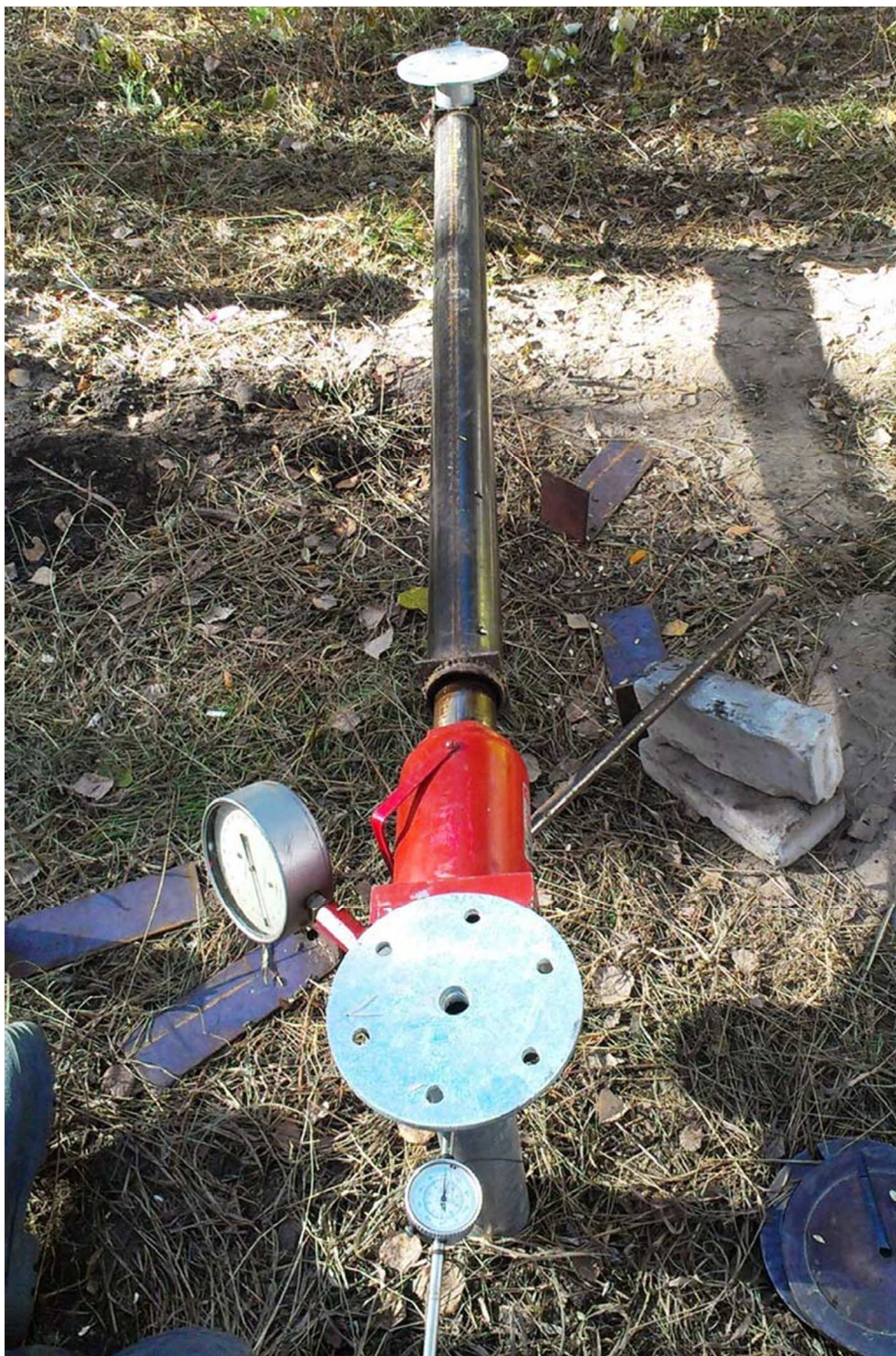
Рисунок 4.2 - Загальний вигляд установки для випробування палів
