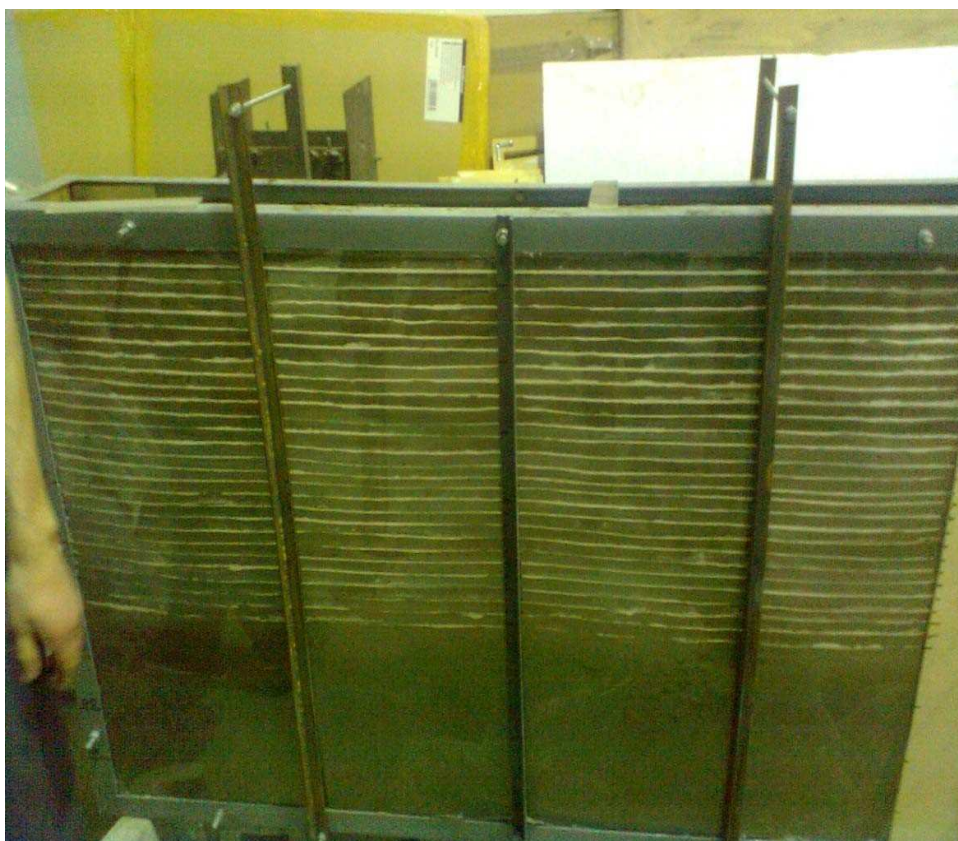
Рисунок 2.3 - Укладений ґрунт в стенд С-01 для модельного випробування
