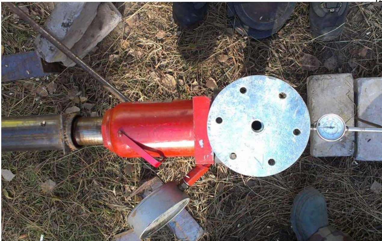
Рисунок 4.1 - Установка індикатора годинникового типу ИЧ-50
