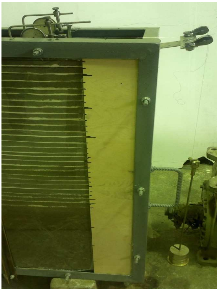
Рисунок 2.4 - Система блоків для передачі горизонтального навантаження
