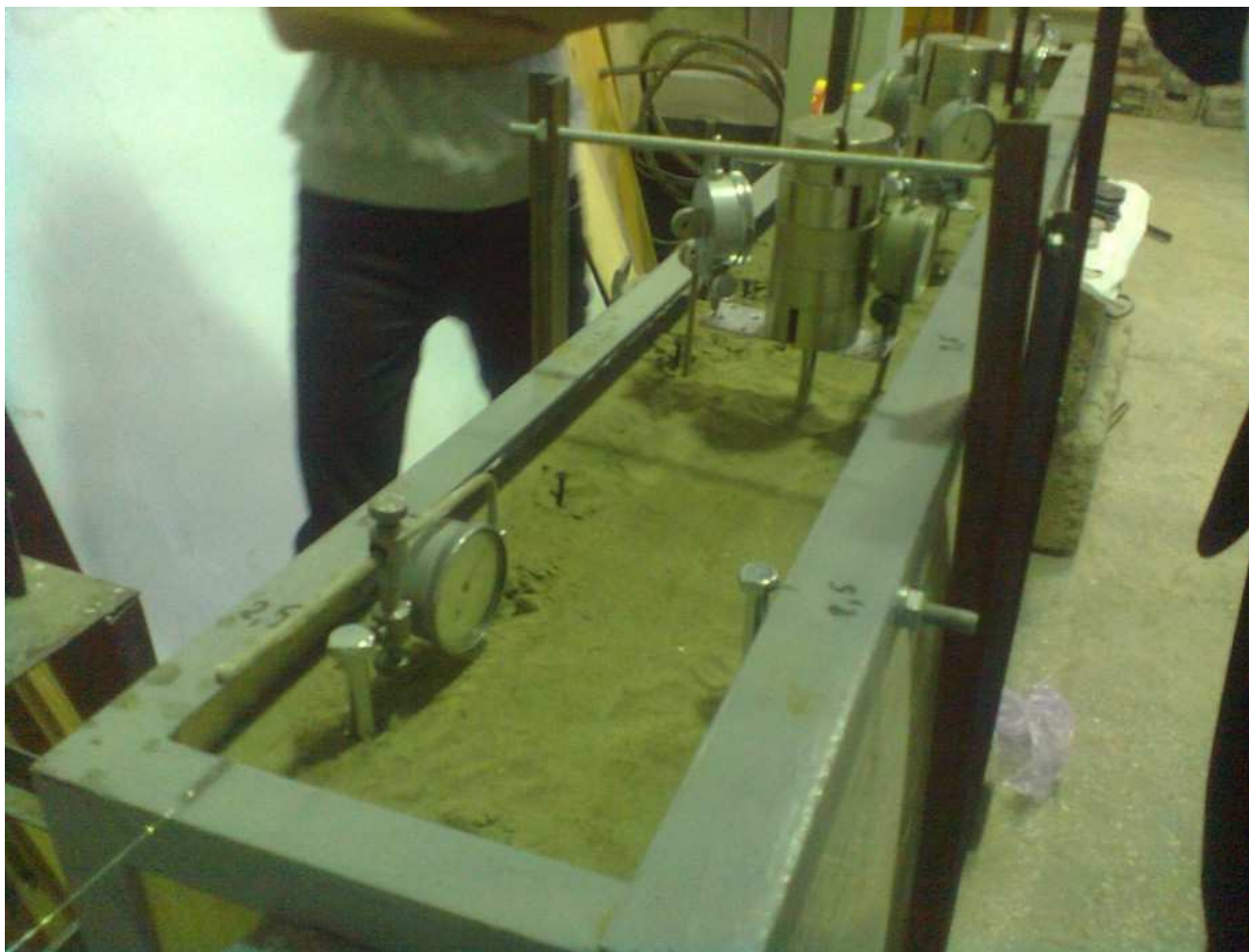
Рисунок 2.7 - Загальний вигляд стенду під час випробувань модельних палей
