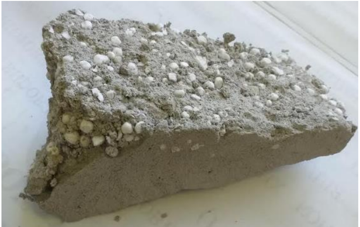
Рисунок 1.2 - Загальний вигляд теплоізоляційного полістиролбетону з фрагментом цементно-піщаного облицювання
