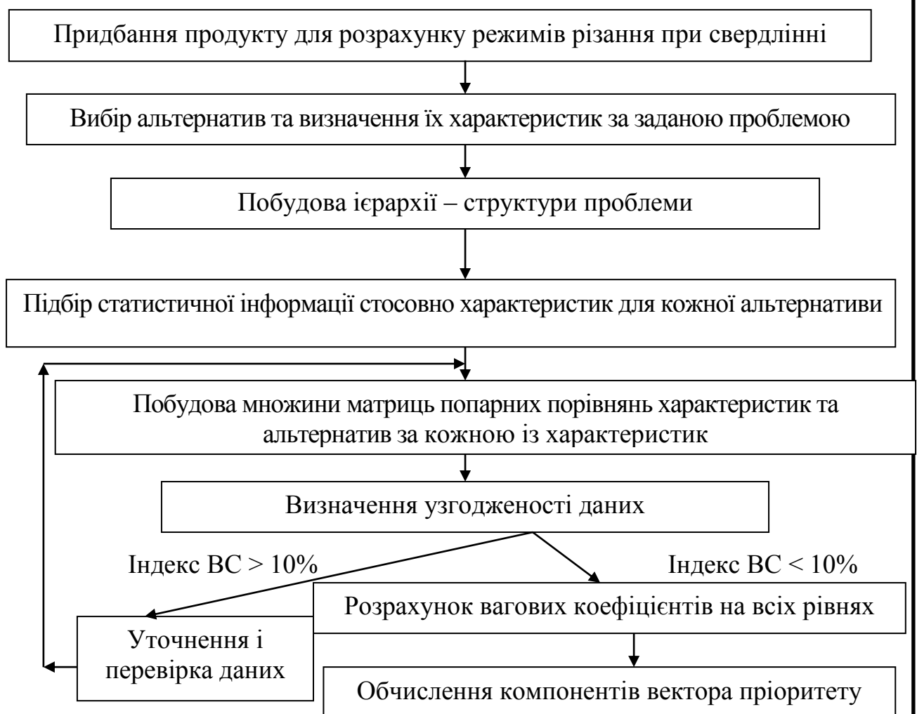
Рисунок 2.10. Алгоритм дій користувача та розрахунків у середовищі системи MPRIORITY 1.0 стосовно вибору раціонального програмного продукту для розрахунку режимів різання при свердлінні
