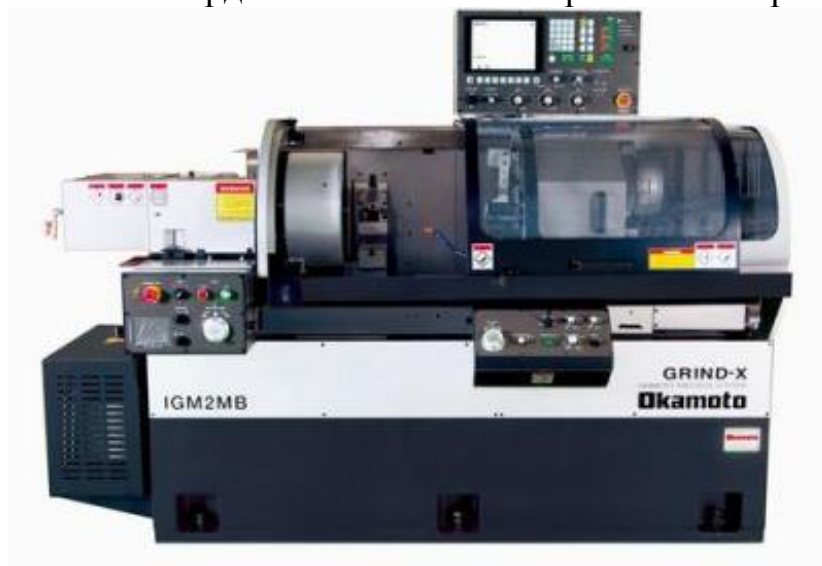
Рисунок 3.5. – Загальний вигляд внутрішньошліфувального верстату моделі IGM-2MB - Серія IGM-MB – Pumori.
