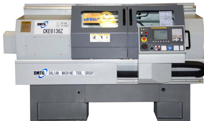
Рисунок 3.2 – Токарно-гвинторізний верстат з ЧПК (Fanuc) моделі СКЕ6136Z 750 (загальний вигляд)
