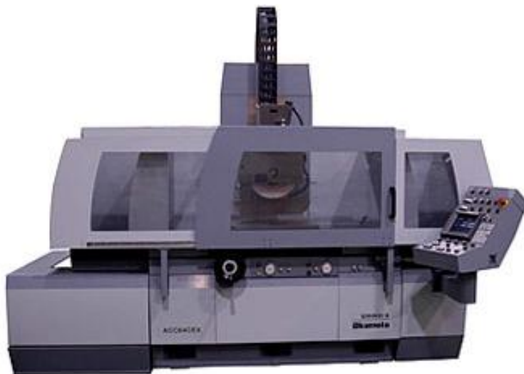
Рисунок 3.7. – Загальний вигляд плоскошліфувального верстату моделі ACC-106CA1 – Puma.
