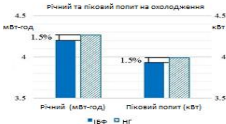
Рисунок 7: Річний та піковий попит на охолодження. Порівняння ІБФ та гібридної конструкції
