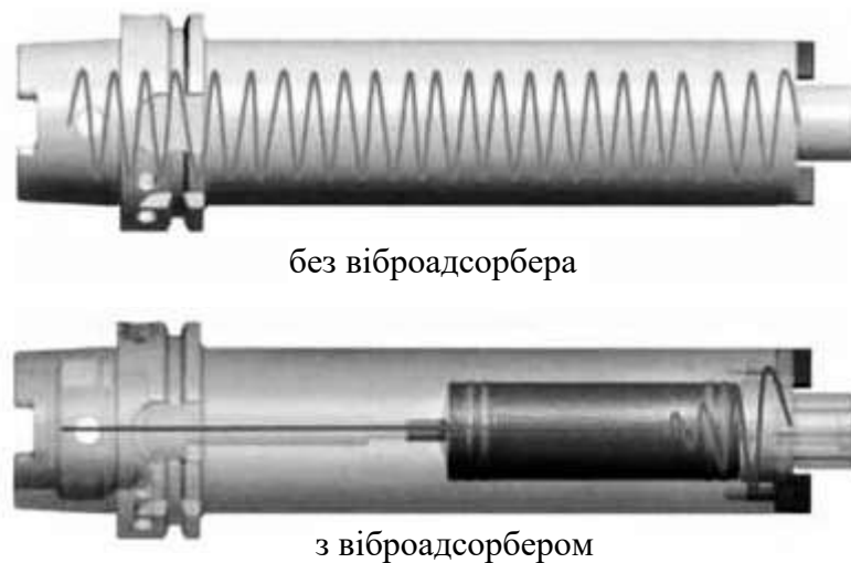
Рисунок 1.6 – Принцип поширення коливань у конструкції оправки без віброадсорбера і з віброадсорбером
