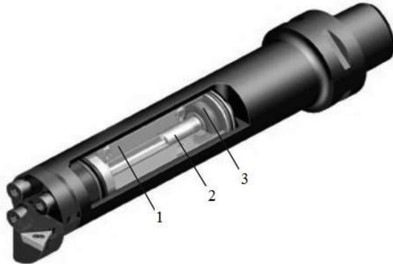
Рисунок 2.7 – Принципова будова антивібраційної оправки: 1 – в'язке мастило; 2 – демпфуюча система з інерційним тілом; 3 – гумові втулки
