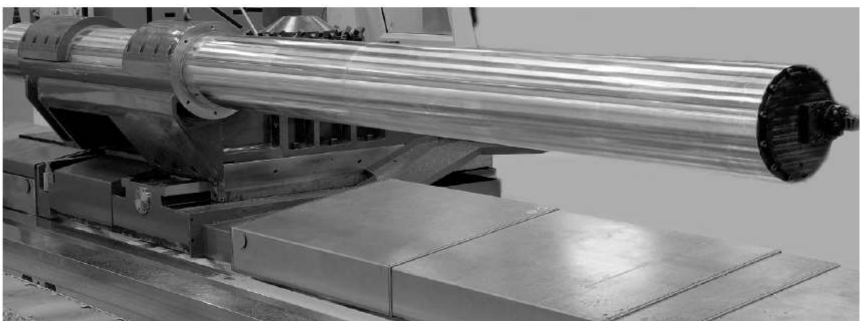
Рисунок 1.4 – Антивібраційна швидкозмінна розточна оправка типу «КороТур» діаметром 300 мм і вильотом 3000 мм (10×D) [19]
