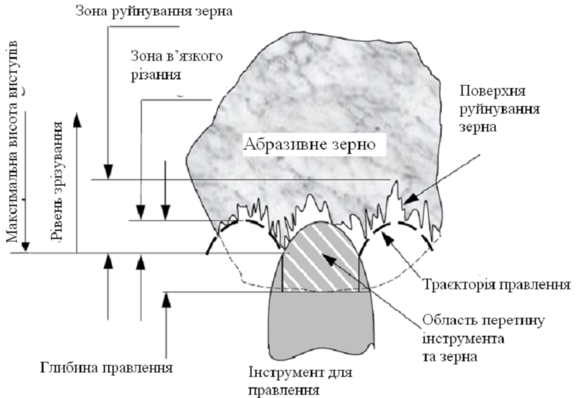
Рисунок 1.5 – Схематичне зображення руйнування зерна однокочковим інструментом для правлення [22]
