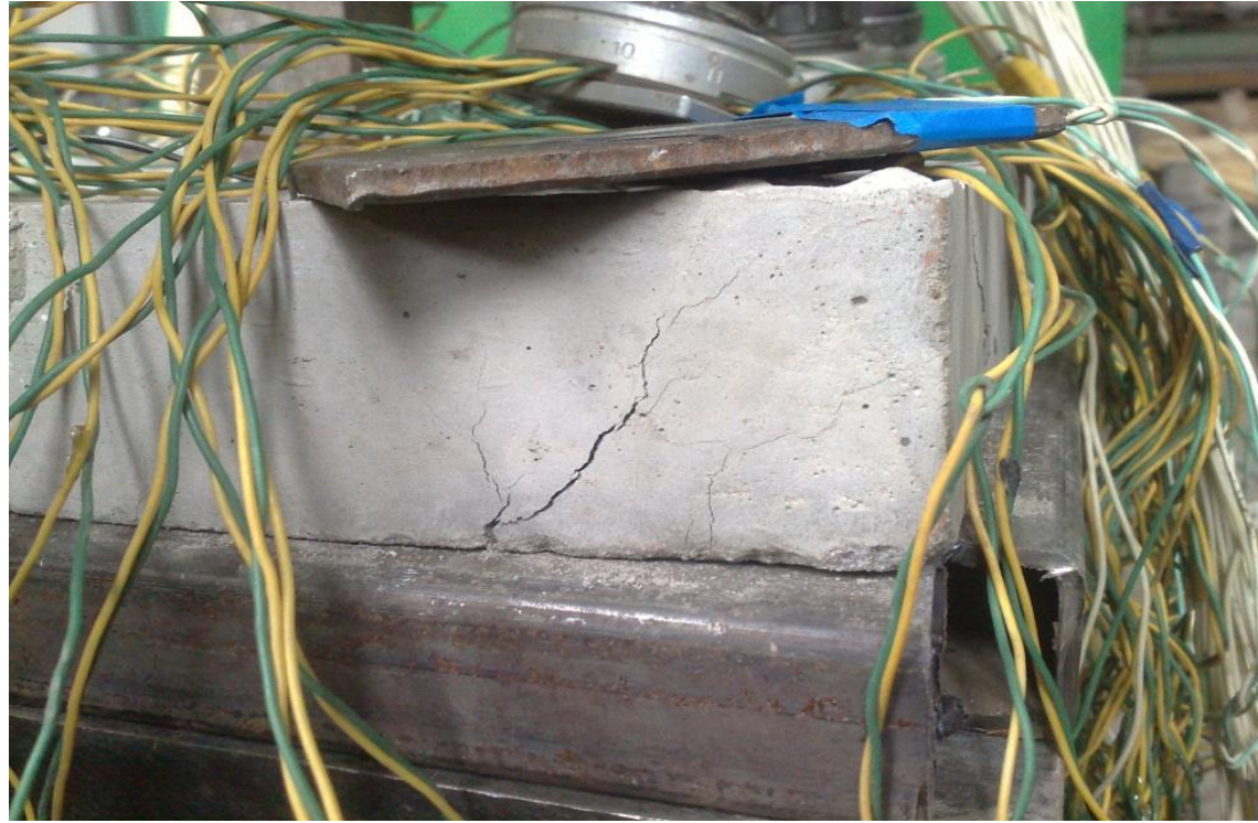
Рис. 6.4 Руйнування плити при навантаженні 12кН
