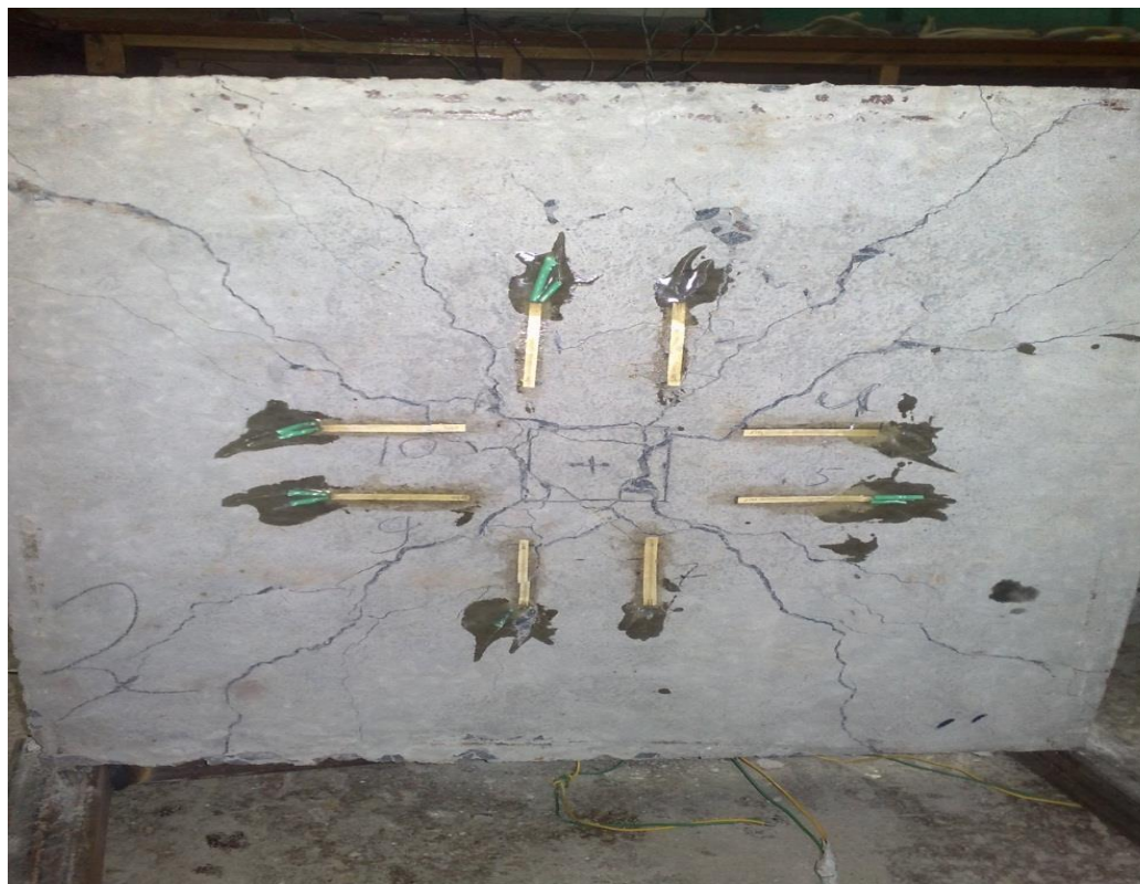
Рис. 6.6 Схема руйнування розтягнутої зони
