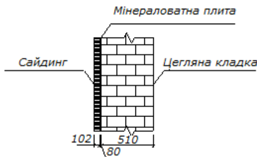
Рисунок 1.1 -Конструкція зовнішньої стіни
