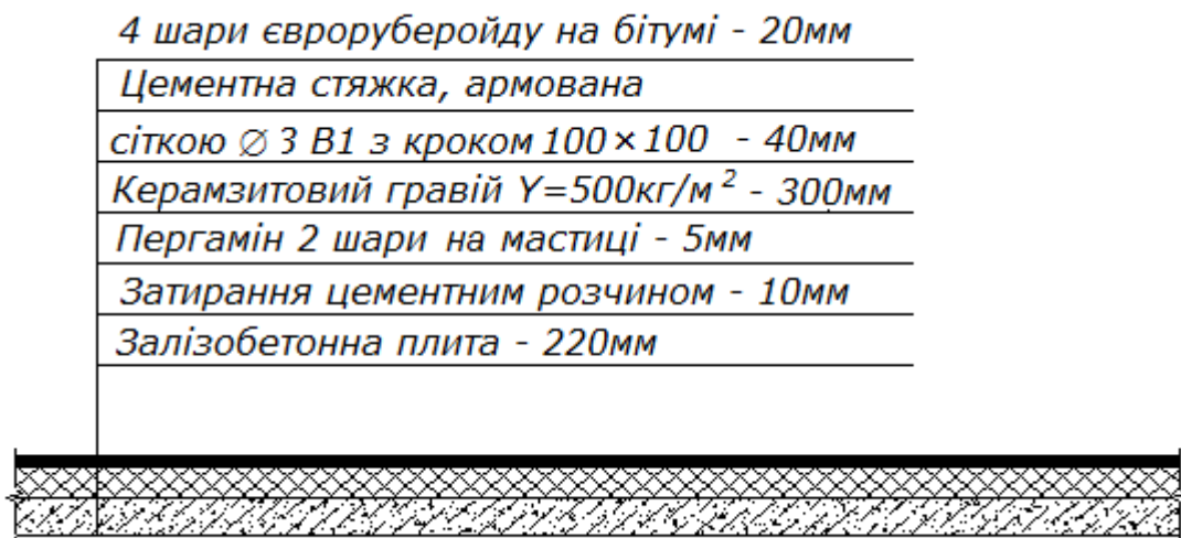
Рис. 1.2 - Конструкція покриття
