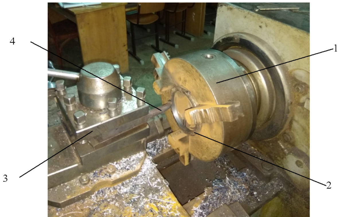
Рисунок 2.2 – Процес розточування гвинтової заготовки на токарно-гвинторізному верстаті 16К20: 1 – трьохкулачковий патрон; 2 – гвинтова заготовка у стиснутому стані; 3 – різцетримач; 4 – розточний різець
