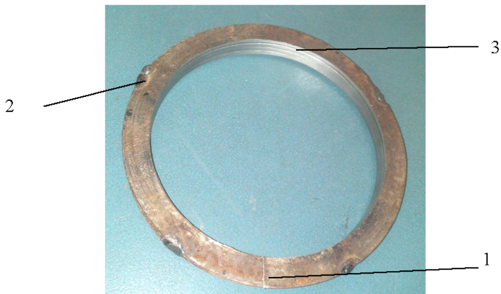
Рисунок 2.1 – Фотографія стиснутої та звареної гвинтової заготовки: 1 – витки гвинтової заготовки; 2 – місця зварювання витків; 3 – розточена поверхня гвинтової заготовки
