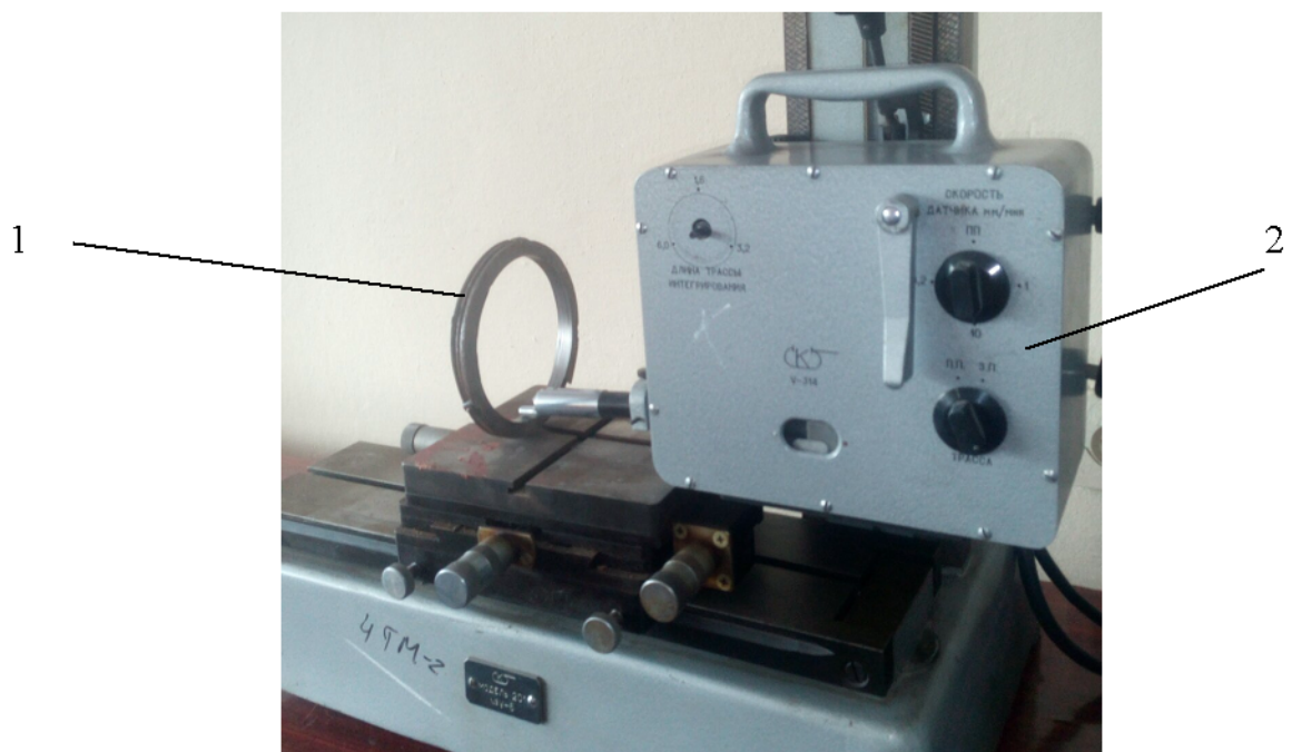
Рисунок 2.3 – Фотографія процесу вимірювання шорсткості розточеної поверхні гвинтової заготовки профілографом-профілометром: 1 – гвинтова заготовка; 2 – профілограф-профілометр
