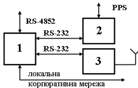
Рис. 1.20. Функціональна структура концентратора системи «Альтра»:
