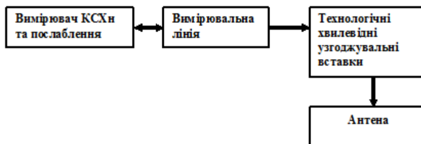
Рисунок 4.3. Вимірювальний лабораторний стенд для визначення КСХн антенного пристрою.
