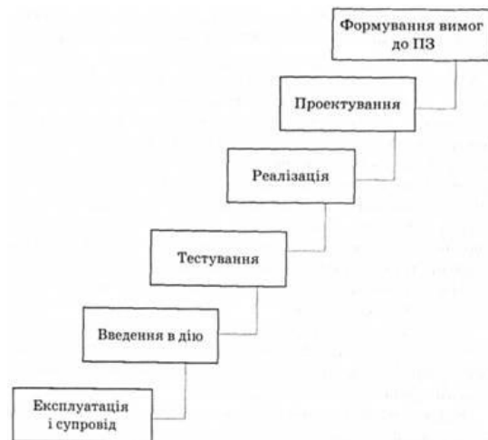
Рисунок 1.1 – Каскадна модель життєвого циклу ПЗ
