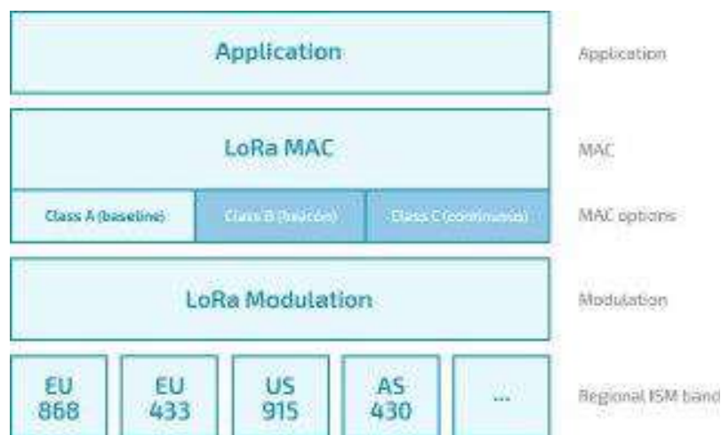
Рисунок 2.1 – Типи пристроїв в мережі LoRaWAN
