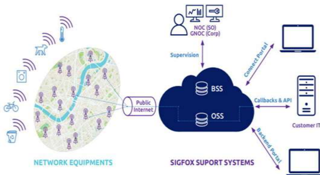
Рисунок 2.3 – Архітектура мережі що базується на технології SigFox
