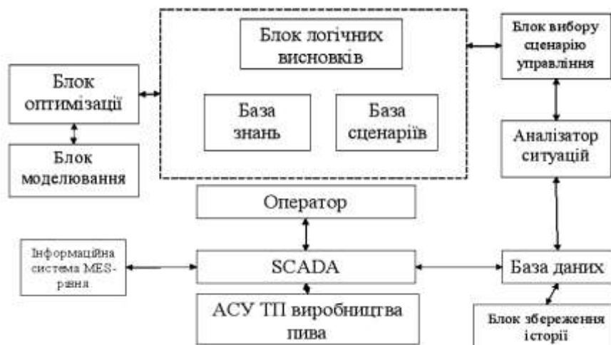
Рисунок 2.11 – Структура системи виготовлення пива
