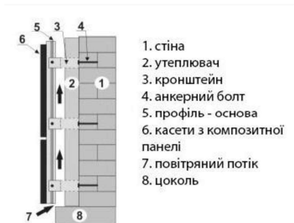
Рис. 2. Розширення вентилязованого фасаду
