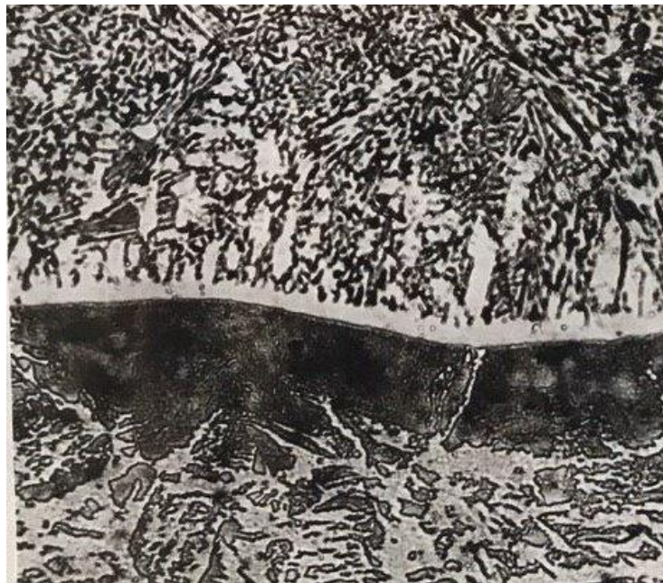
Рисунок 2.3 – Мікроструктура наплавленого зразку Б при змінній потужності: а – наплавлений шар X 200; б – перехідна зона X 200.
