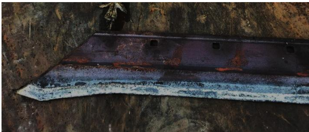
Рисунок 3.4 - Макрошліф поперечного перерізу леза леміша напавлений псевдо сплавом ПГ УС25
