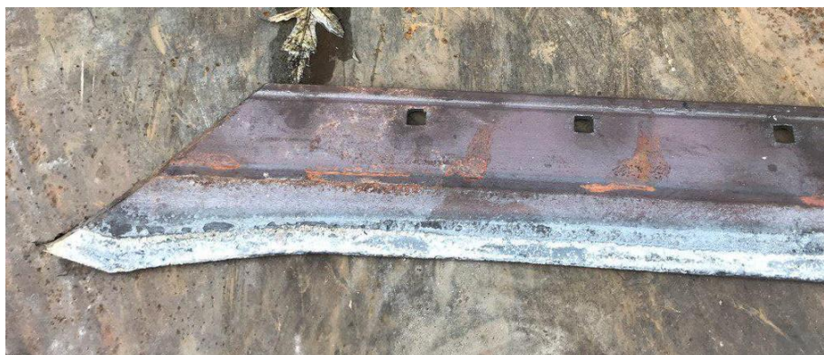
Рисунок 1.1 – Загальний вигляд леміша
