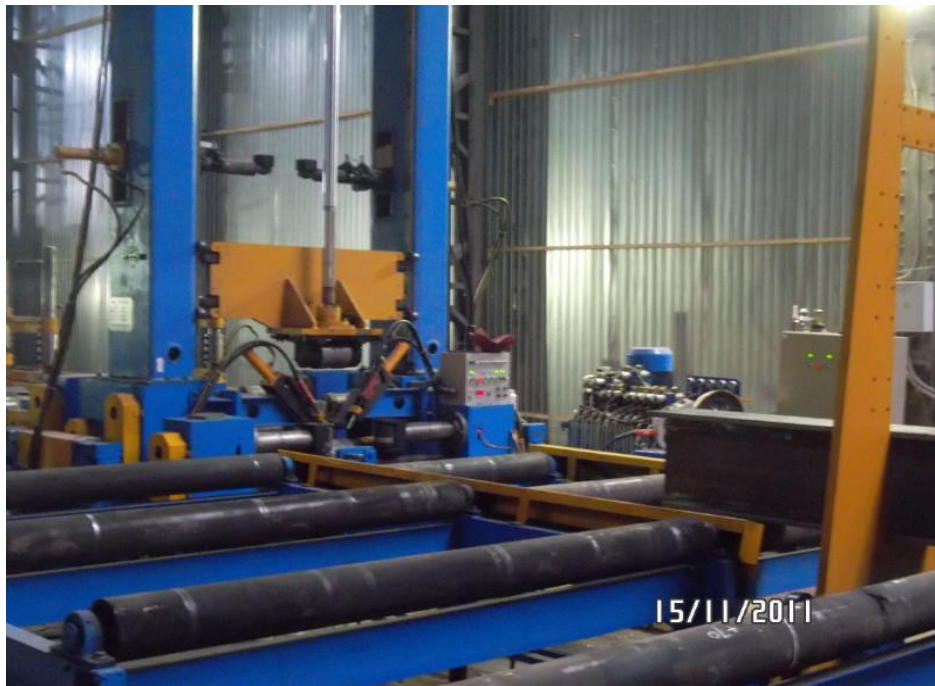
Рисунок 4.5 Автоматична машина для складання та прихоплення двотаврових балок, машина моделі Mach Trac 2500.
