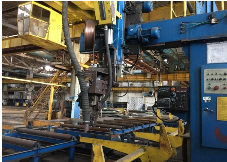
Рисунок 4.7 - Рольган і автоматично зварювальни машина під шаром флюсу.
