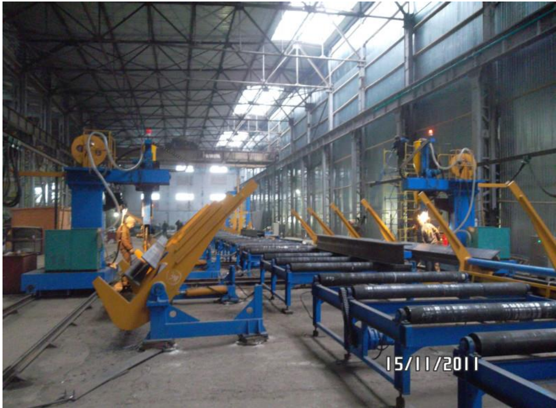
Рисунок 4.1 - Загальний вигляд автоматизованої, механізованої зварювальної дільниці.
