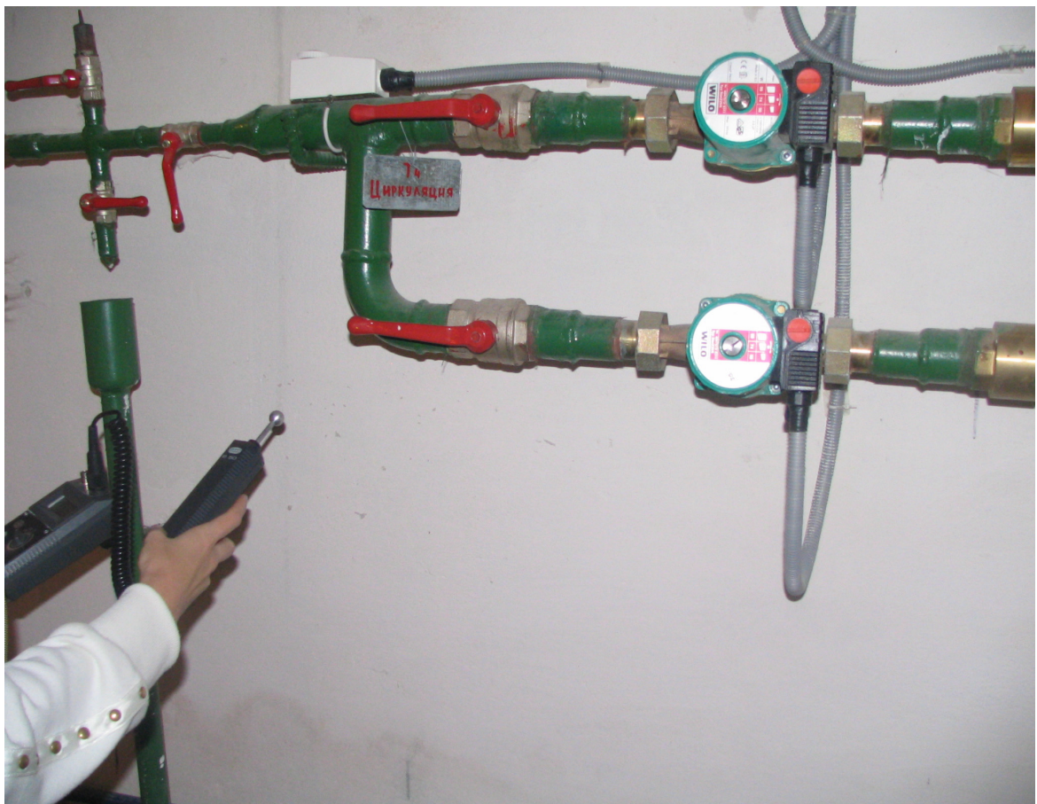
Рис. 2.8. Проведення вимірювань вологості конструкції кондуктометричним методом
