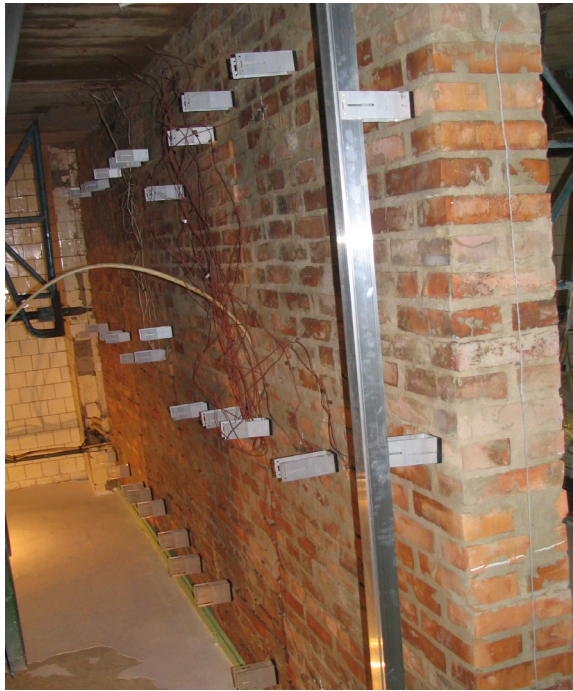
Рис. 2.6. Вид дослідної стінової конструкції з фасадною теплоізоляцією при її монтажу в прорізі кліматичної камери
