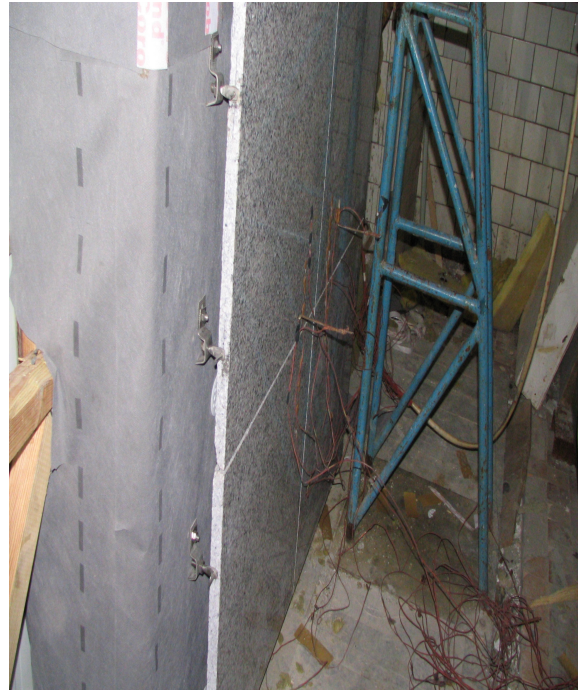
Рис. 2.6. Вид дослідної стінової конструкції з фасадною теплоізоляцією при її монтажу в прорізі кліматичної камери
