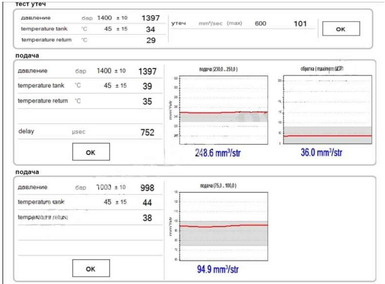
Рисунок 3.4 – Результати тестування форсунки
