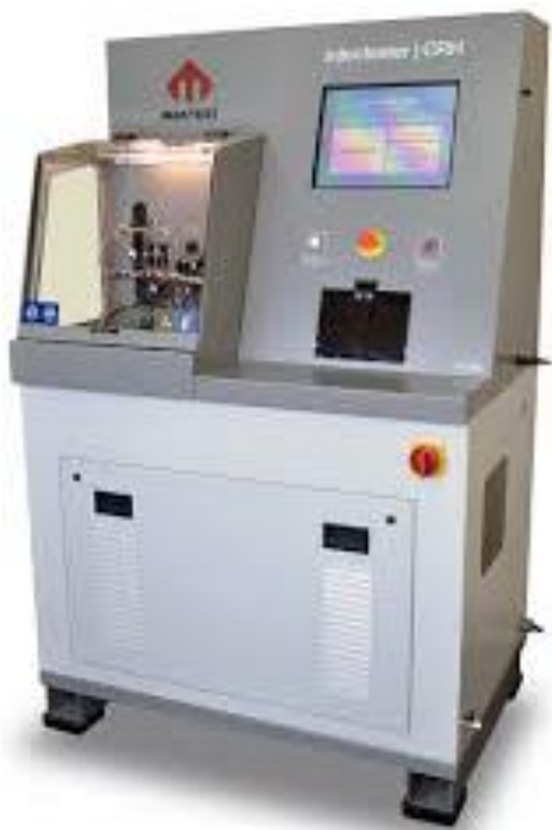
Рисунок 3.1 – Стенд ТК 1029-01 для ремонту дизельних форсунок
