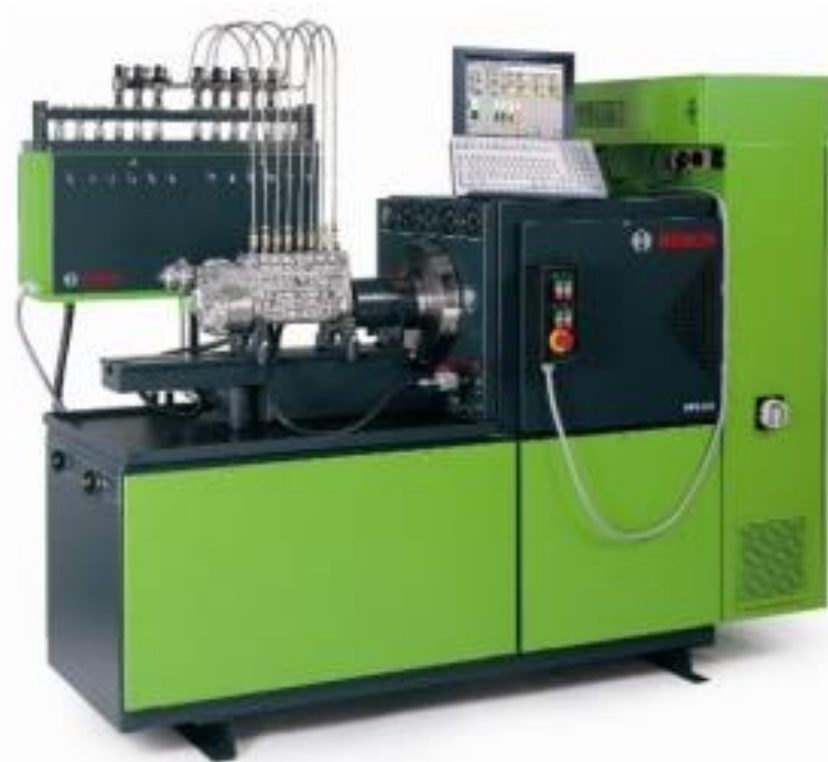
Рисунок 3.6 – Стенд для діагностики ТНВД EPS 815
