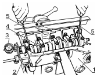
Рисунок 2.17 – Схема перевірки осьового зазору колінвала.
