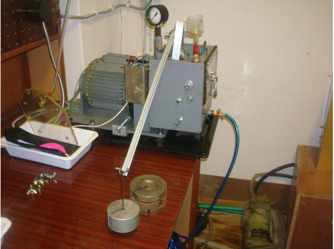
Рисунок 5.6 – Тарування давача насоса
