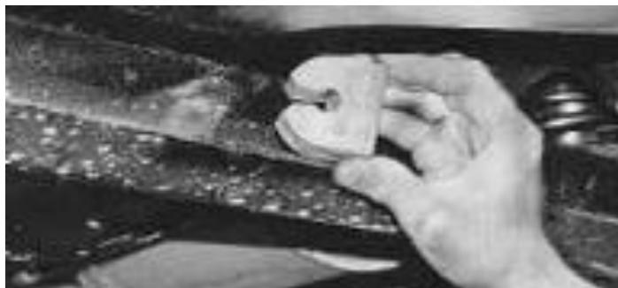
Рисунок 2.24 – Зняття гумової подушки стабілізатора
