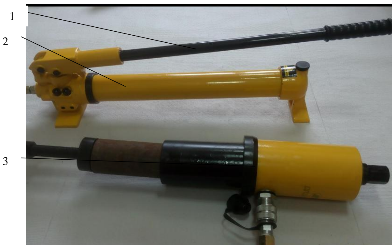
Рисунок 3.3 - Гідравлічне пристосування для заміни сайлентблоків:
