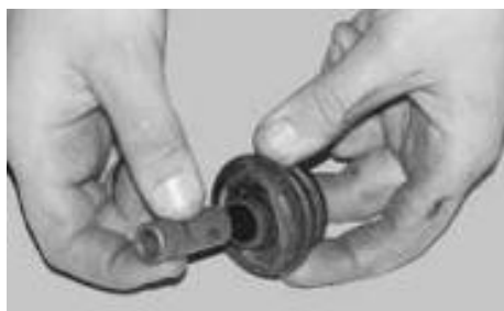
Рисунок 2.15 – Виймання розпірної втулки з подушки
