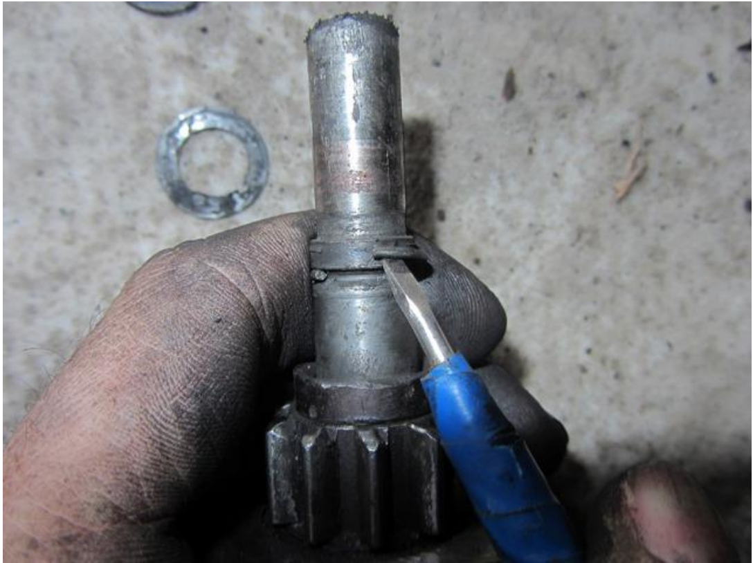
Рисунок 2.9 – Зняття штопорного кільця
