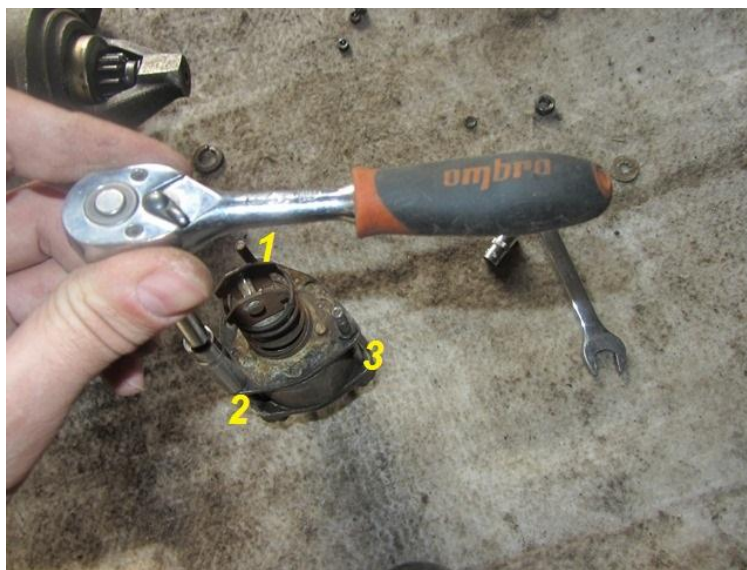
Рисунок 2.14 – Розкручування тягового реле
