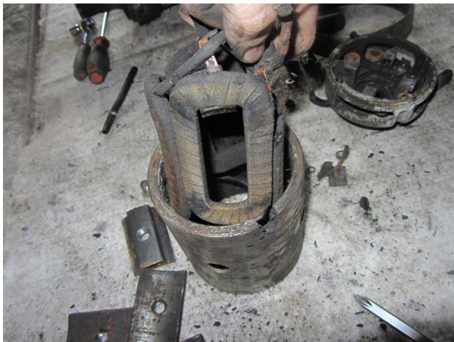
Рисунок 2.6 – Зняття платин що підтримують обмотку
