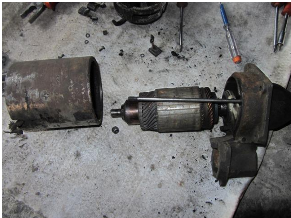
Рисунок 2.4 – Зняття корпусу з шпильки
