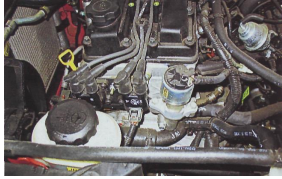
Рисунок 2.3 - Заміна свічок запалювання на автомобілі «Шевроле-Лачетті» (двигун F16D, 1,6 л, 109 к.с.)
