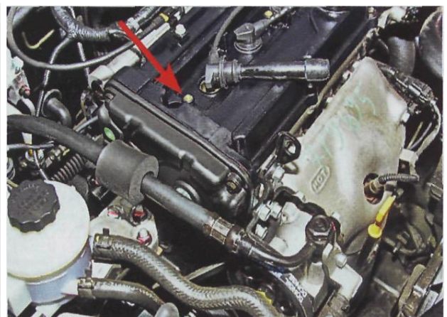
Рисунок 2.2 - Заміна свічок запалювання на автомобілі «Хендай-Акцент» (двигун G43D, 1,6 л, 107 к.с.)
