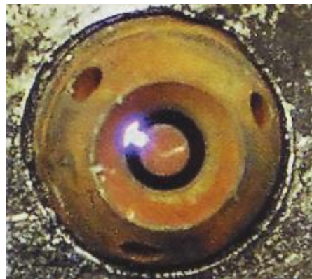
Рис. 5.3 - Український “Плазмафор” до (а) і після (б) роботи на бензині з підвищеним змістом ферроцену.
