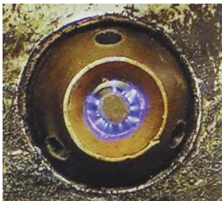
Рис. 5.3 - Український “Плазмафор” до (а) і після (б) роботи на бензині з підвищеним змістом ферроцену.
