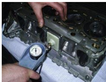
Рисунок 2.8. - Перевірка герметичності спряження “сідло клапана - клапан”
