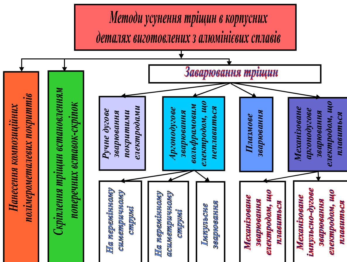
Рисунок 5.1 - Класифікація методів усунення тріщин в корпусних деталях з алюмінієвих сплавів
