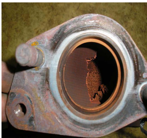
Рисунок 5.6. - Викришування керамічного блоку каталітичного нейтралізатора
