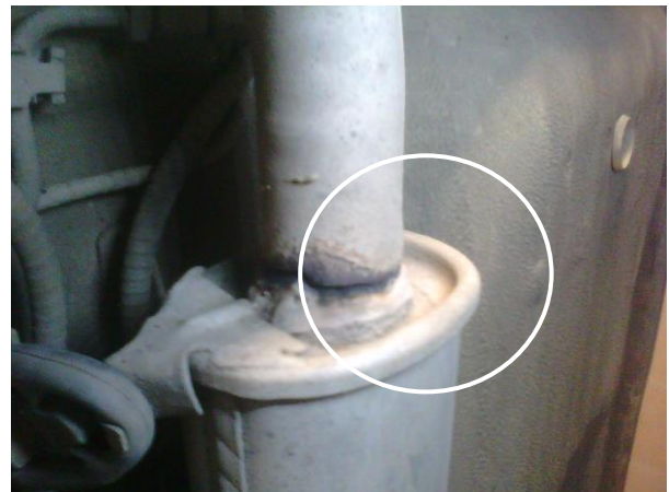
Рисунок 1.15 - Поломка сполучних труб глушників спричинена вібрацією
