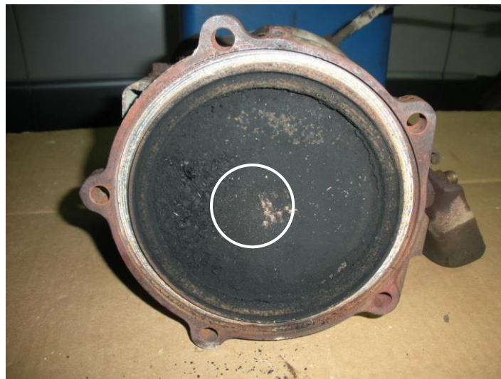
Рисунок 1.12 - Осадження шлакових відкладень на поверхнях сот нейтралізатора
