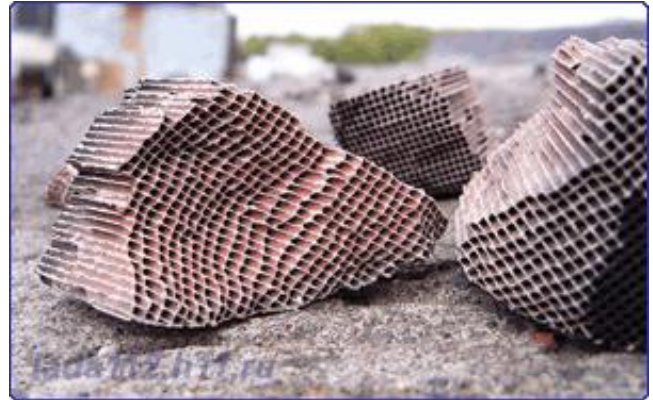
Рисунок 1.14 - Викришування керамічного блоку каталітичного нейтралізатора
