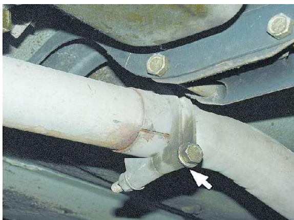
Рисунок 3.3. - З'єднання елементів випускних систем по трубопроводах
