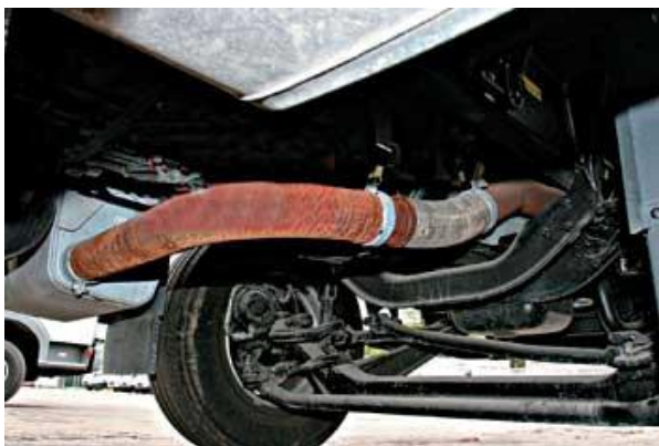
Рисунок 1.10. - Іржа у випускній системі автомобіля
