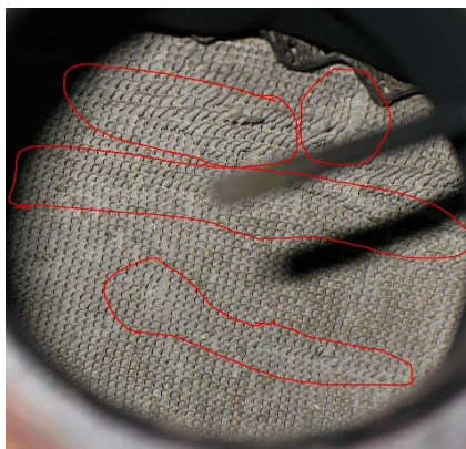
Рисунок 2.4 – Забиті соти каталітичного нейтралізатора, що перешкоджають руху відпрацьованих газів та підвищують рівень тиску у випускній системі
