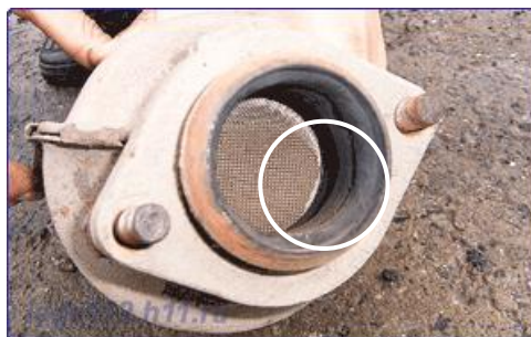
Рисунок 5.1. - Осадження свинцевих відкладень на поверхнях сот нейтралізатора
