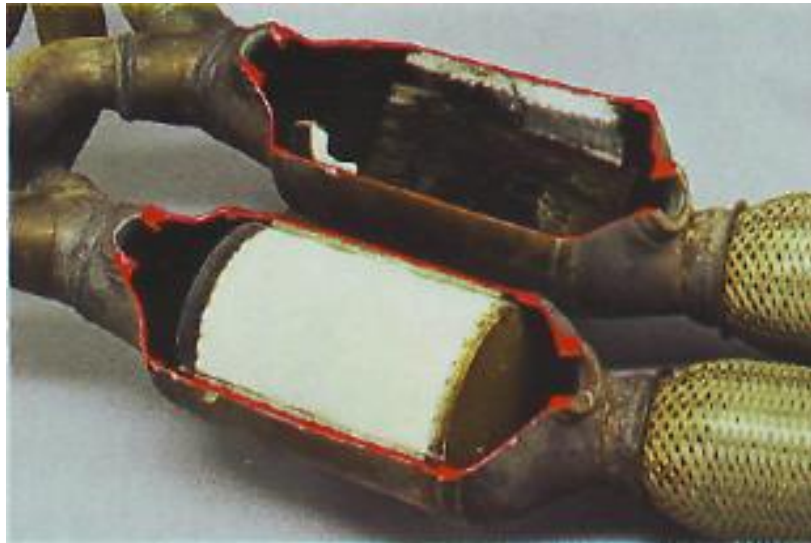
Рисунок 5.3. - Вихід з ладу нейтралізатора відпрацьованих газів системи випуску автомобіля: оплавлення керамічних сот.
