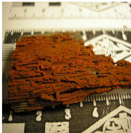
Рисунок 5.4. – Забивання сот каталізатора під впливом залізовмісних присадок
