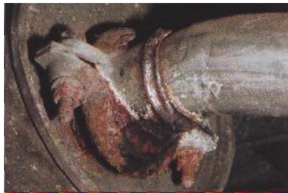
Рисунок 1.10. - Іржа у випускній системі автомобіля
