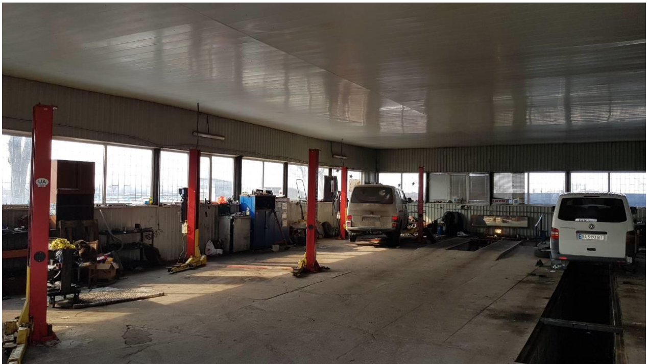
Рисунок 1.2. – Основна виробнича зона ПП «Ковальов-Авто», призначена для виконання комплексних робіт з ТО і ремонту 1800 автомобілів за рік
