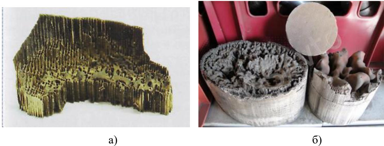
Рисунок 1.11 - Вихід з ладу нейтралізатора відпрацьованих газів системи випуску автомобіля:
