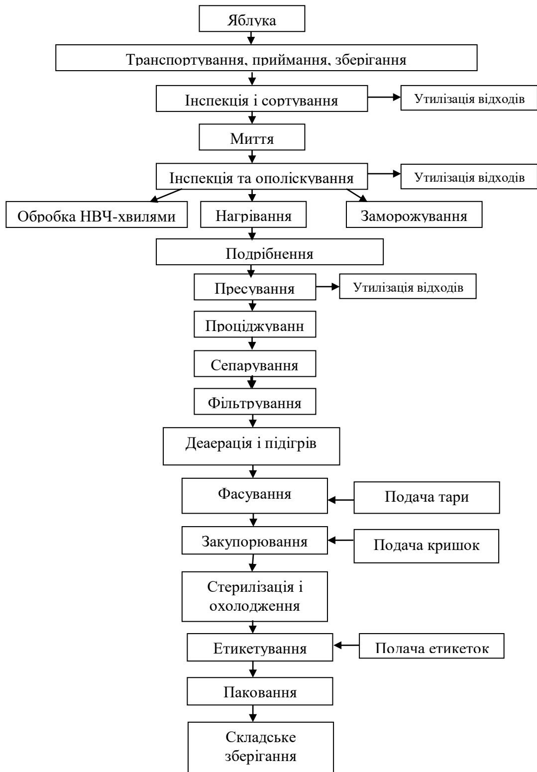
Рис. 4.1. Технологічна схема виробництва натурального яблучного соку неосвітленого
