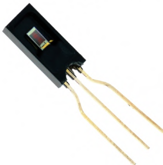
Рис. 2.28. Зовнішній вигляд і розміри датчика HIH 3610-004
