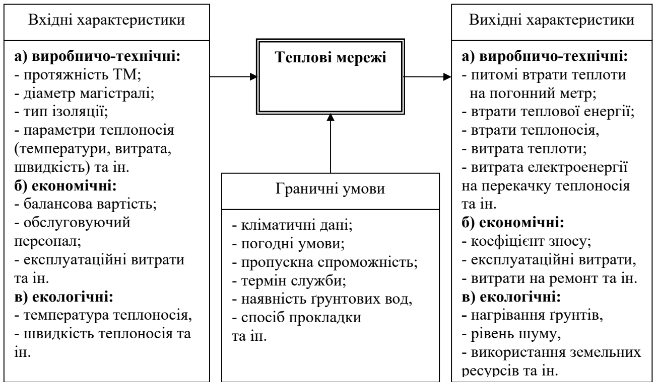
Рис. 1.3. Схема показників ефективності теплових мереж
