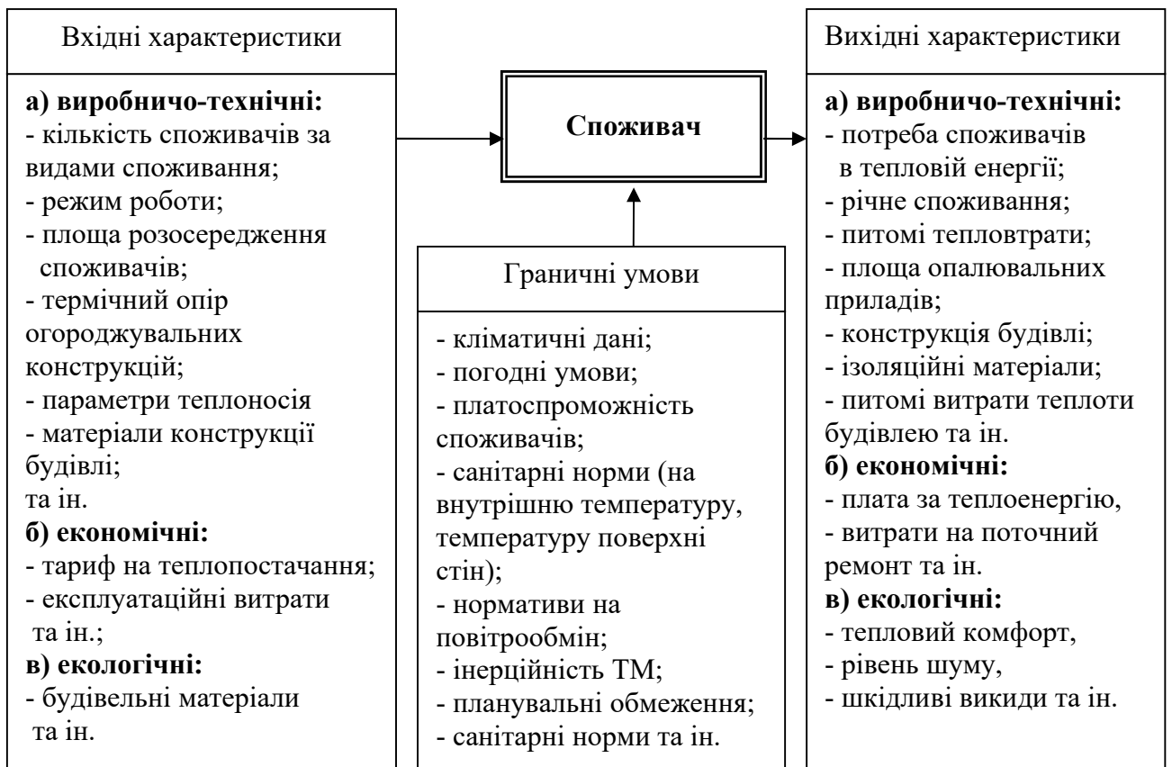
Рис. 1.4. Схема показників ефективності теплоспоживання споживачів теплової енергії
