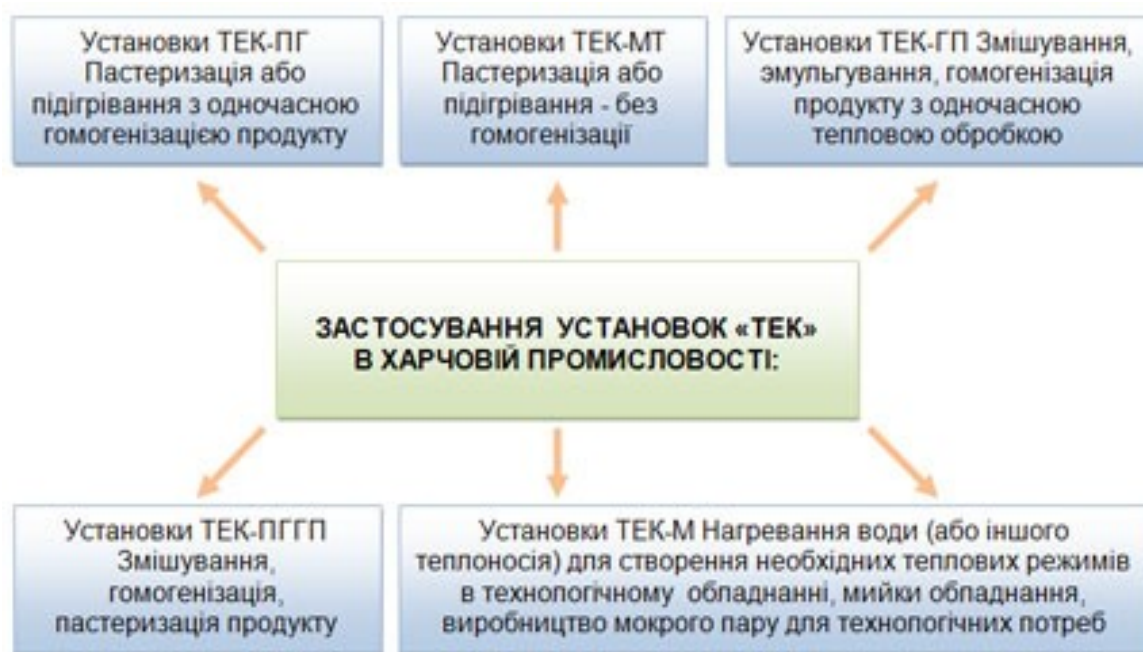
Рис. 2.12. Схема застосування гідродинамічних установок в харчовій промисловості.
