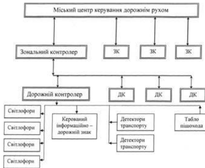
Рисунок 4.2 – Ієрархічна структура системи керування дорожнім рухом
